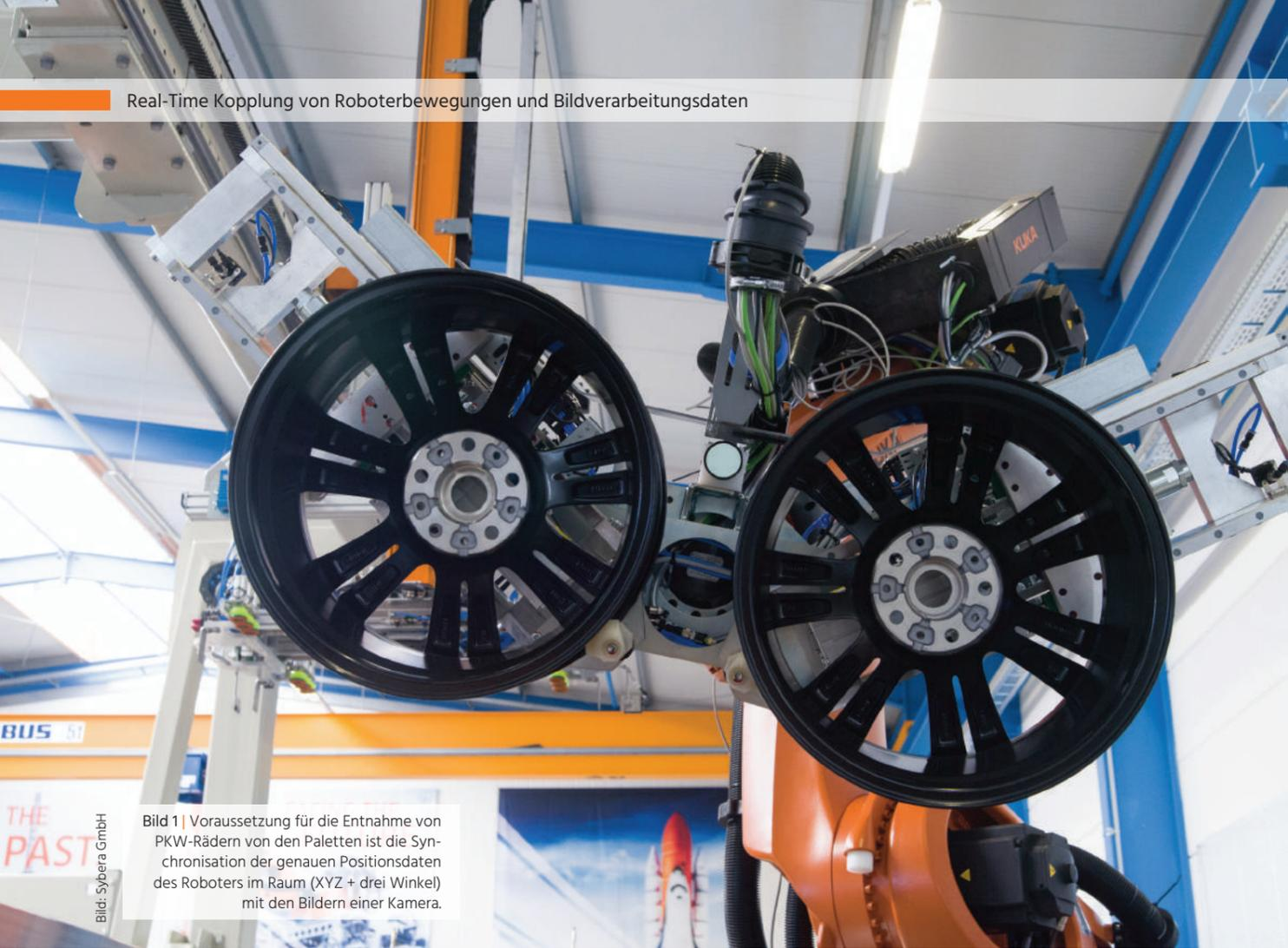
Bild 1 | Voraussetzung für die Entnahme von PKW-Rädern von den Paletten ist die Synchronisation der genauen Positionsdaten des Roboters im Raum (XYZ + drei Winkel) mit den Bildern einer Kamera.
