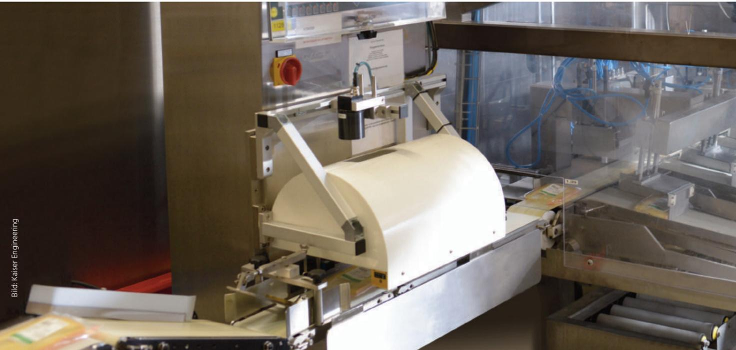
Bild 1 | Die Käseverpackungen laufen an dieser Station von links kommend unter dem Bildverarbeitungssystem hindurch und werden nach der Inspektion von einem Roboter in Transportkisten abgelegt.
