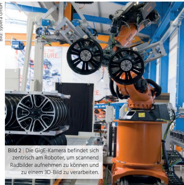
Bild 2 | Die GigE-Kamera befindet sich zentrisch am Roboter, um scannend Radbilder aufnehmen zu können und zu einem 3D-Bild zu verarbeiten.
