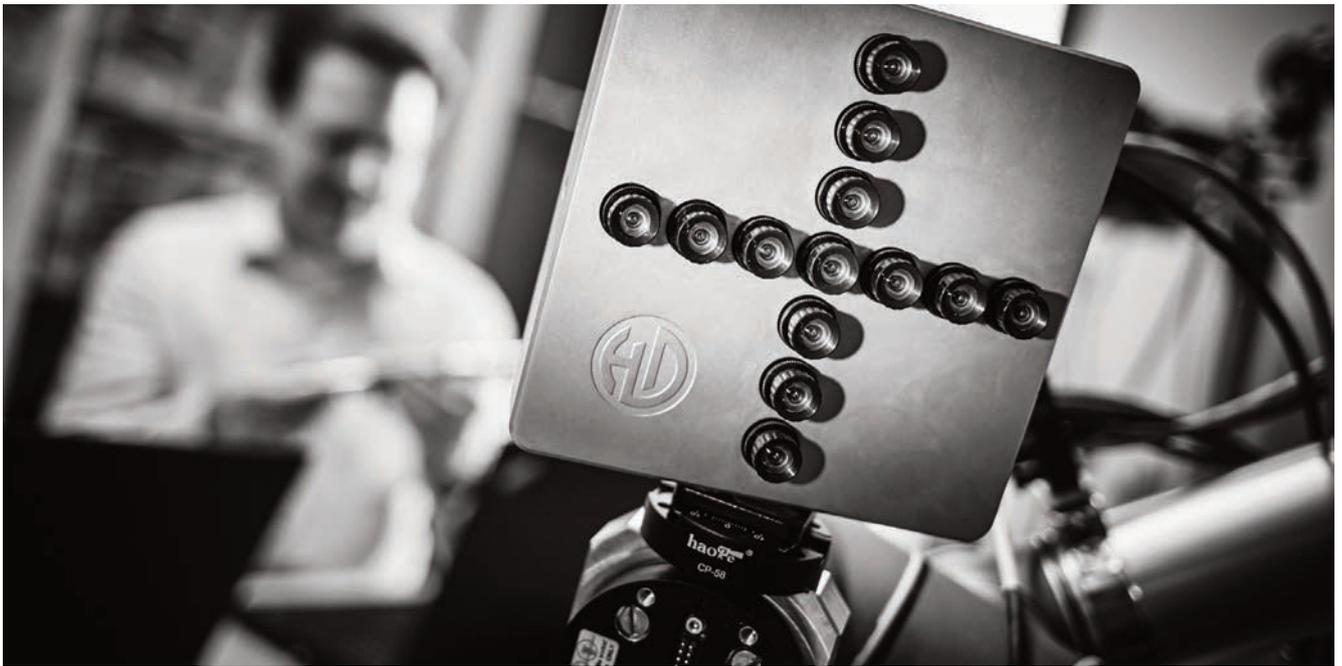
Bild 1 | HD Vision Systems nutzt die Lichtfeld-Technologie, um komplexe Objekte beim Bin Picking vollautomatisiert mit den dreizehn Kameras des LumiScan X Systems in 3D zu lokalisieren.
