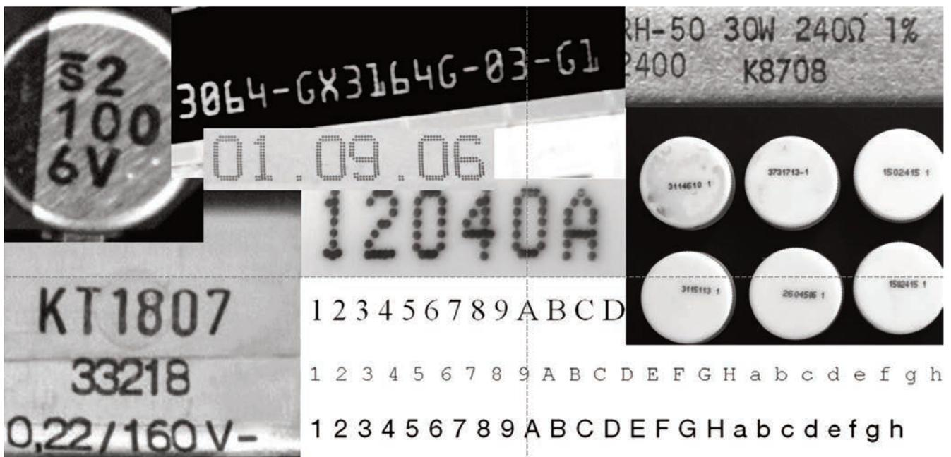
Bild 1 | Mit Deep OCR ist in Halcon erstmalig ein ganzheitlich Deep-Learning-basierter OCR-Ansatz verfügbar, mit dem Texte unabhängig von Orientierung, Schrifttyp und Polarität im Bild gefunden werden können.
