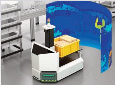
Die 3D-Kamera-Technik HemiStereo von 3Dvisionlabs ermöglicht erstmals eine hemisphärische Tiefenerfassung. Dabei wird der gesamte Halbraum vor der Kamera dreidimensional vermessen, was einem Öffnungswinkel von 180×180° (HxV) entspricht.
