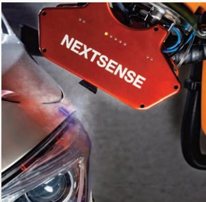
Mit der patentierten CaliBreeze Technologie von Nextsense sind mobile Inline-Profil- und Spaltmessungen sowie Oberflächeninspektionen oberflächenunabhängig möglich. Dabei wird mittels einem hauchdünnen Kondenswasserfilm ein optischer Kontrast auf dem Messobjekt erzeugt.
