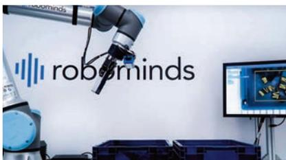
Das smarte Bin Picking System robobrain.vision ermöglicht den Griff unbekannter Bauteile aus Kisten – koordinat-
