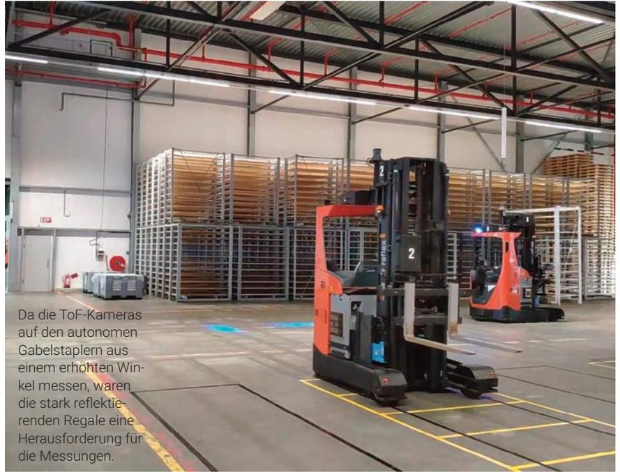
Da die ToF-Kameras auf den autonomen Gabelstaplern aus einem erhöhten Winkel messen, waren die stark reflektierenden Regale eine Herausforderung für die Messungen.
