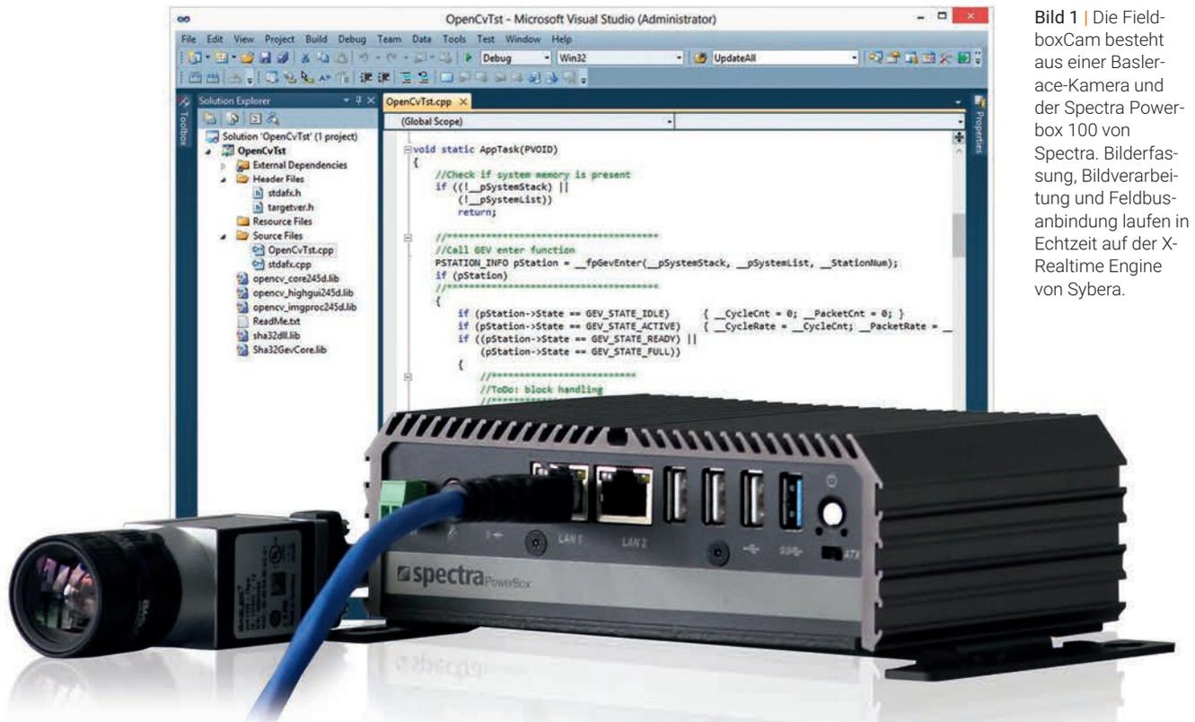
**Bild 1** | Die FieldboxCam besteht aus einer Baslerace-Kamera und der Spectra Powerbox 100 von Spectra. Bilderfassung, Bildverarbeitung und Feldbusanbindung laufen in Echtzeit auf der X-Realtime Engine von Sybera.
