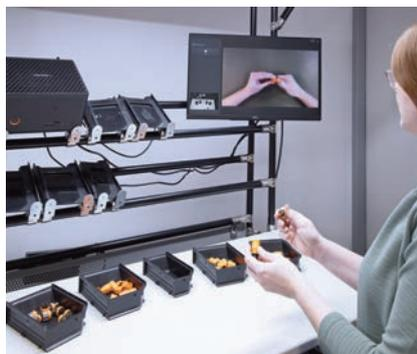
einem Rechner mit Touchmonitor, der Software und einem optischen Sensor, der sowohl ein 2D-Videobild als auch ein 3D-Bild aufnimmt. Die Arbeitsabläufe lassen sich in der Software flexibel definieren. Optional erhältlich ist ein kombinierter optischer und akustischer Signalgeber, der den Werker direkt im Blickfeld auf Fehler hinweist.
