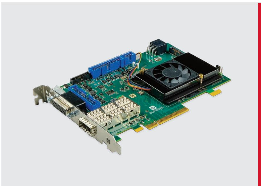
**Der Framegrabber (dt. Bild-erfassungskarte) ist ein Rechner-Board, das die verlustfreie Datenübertragung von Kamera(s) zum Rechner sichert. Aktuelle Grabber stellen dazu digitale Kamera-Interfaces und Spannungsversorgung Power over ... für verschiedene Kameratypen bereit.**
