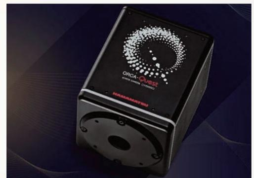
Die C15550-20UP von Hamamatsu Photonics ist die erste Kamera mit einem quantitativen CMOS-Bildsensor (qCMOS), der die Anzahl der Photoelektronen auflösen kann. Die Orca Quest hat ein Rauschen von 0,27 Elektronen rms, eine Auflösung von 9,4MP und einen Dunkelstrom von 0,006 Elektronen/Pixel/s bei -35°C.
