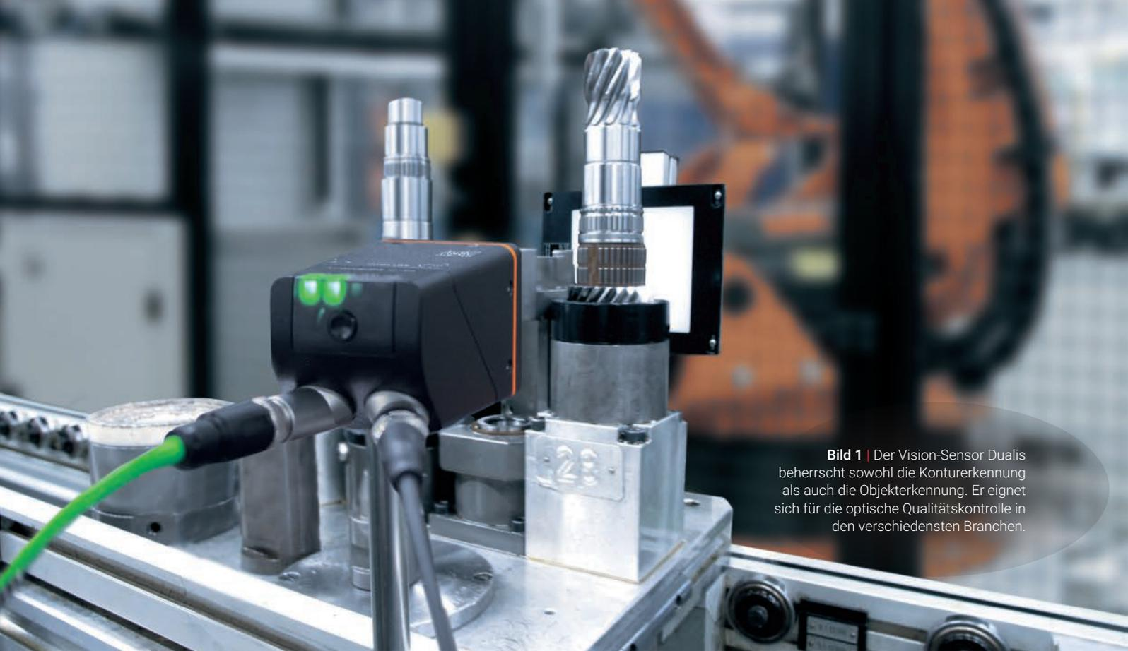
**Bild 1** | Der Vision-Sensor Dualis beherrscht sowohl die Konturerkennung als auch die Objekterkennung. Er eignet sich für die optische Qualitätskontrolle in den verschiedensten Branchen.
