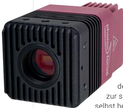
Die photon3D-Kamera MV4-D2048-L01-3D06-GT zur Lasertriangulation von Photonfocus ist mit dem Luxima LUX2810 Sensor ausgestattet, der eine Scanrate von bis zu 100kHz bietet. Die Kamera verfügt über den LineFinder-Algorithmus zur sicheren Laserliniendetektion, selbst bei extremen Reflektionen wie z.B. bei Metall.
