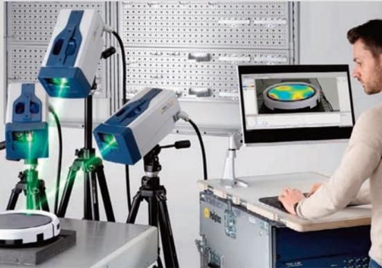
Die PSV QTec Scanning Vibrometer von Polytec ermöglichen die flächenhafte optische Messung von Schwingformen. Die Vibrometer nutzen mehrere Detektionskanäle aus unterschiedlichen Perspektiven und kombinieren sie zu einem Gesamtsignal mit hohem Signal-Rausch-Verhältnis. Dabei steigt die nutzbare Auflösung um bis zu 20dB.
