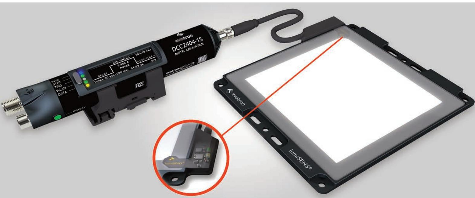
**Bild 1** | Die lumisens-Technologie vereint Beleuchtungscontroller und Beleuchtung (hier OLED-Flächenbeleuchtung A102x102) zu einer digitalen Einheit. Der Light-Sensor-Processor ermittelt mit seiner Sensorik kontinuierlich Ist-Werte der Beleuchtung und überträgt diese an den Controller zur digitalen Regelung des Lichts. - Durch Duplizieren eines digitalen Parametersatzes können Beleuchtungen mit identischen lichttechnischen Daten erstellt werden.
