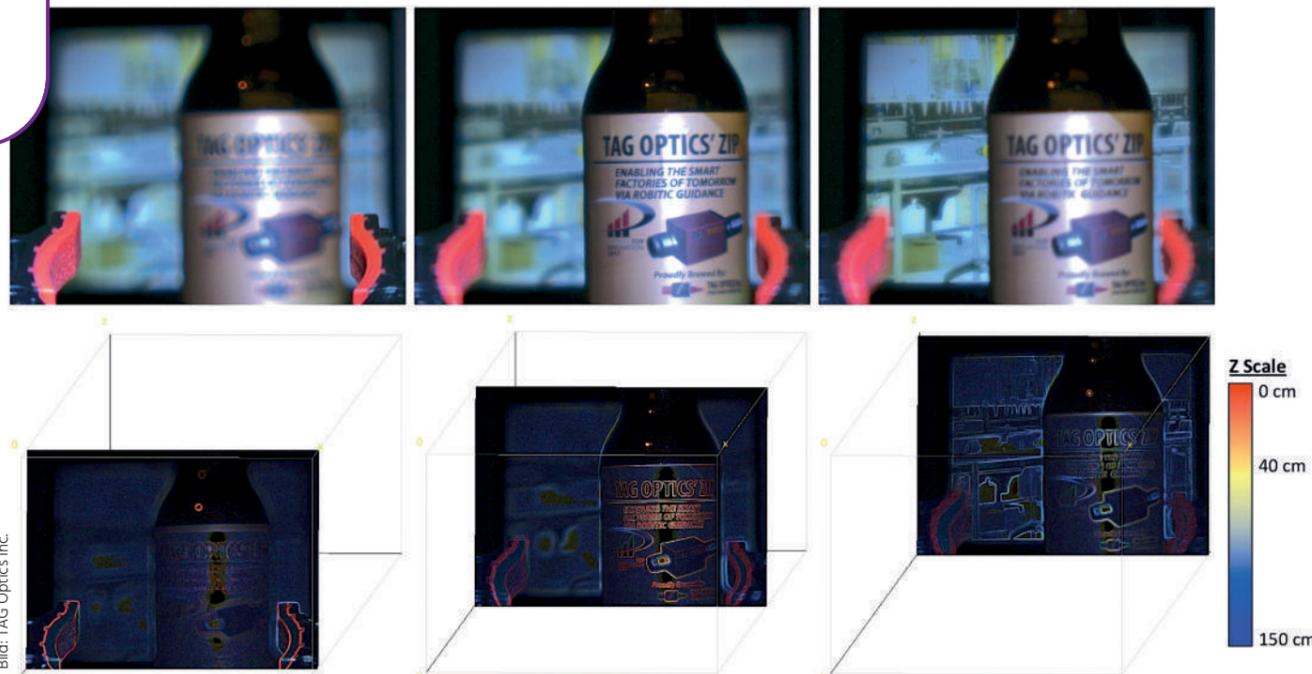
Bild 1 | Die Flüssiglense TAG Lens fokussiert sich mit bis zu 70kHz auf ein bestimmtes Objekt, um eine Vielzahl an Bildern aufzunehmen und so 3D-Informationen zu gewinnen.
