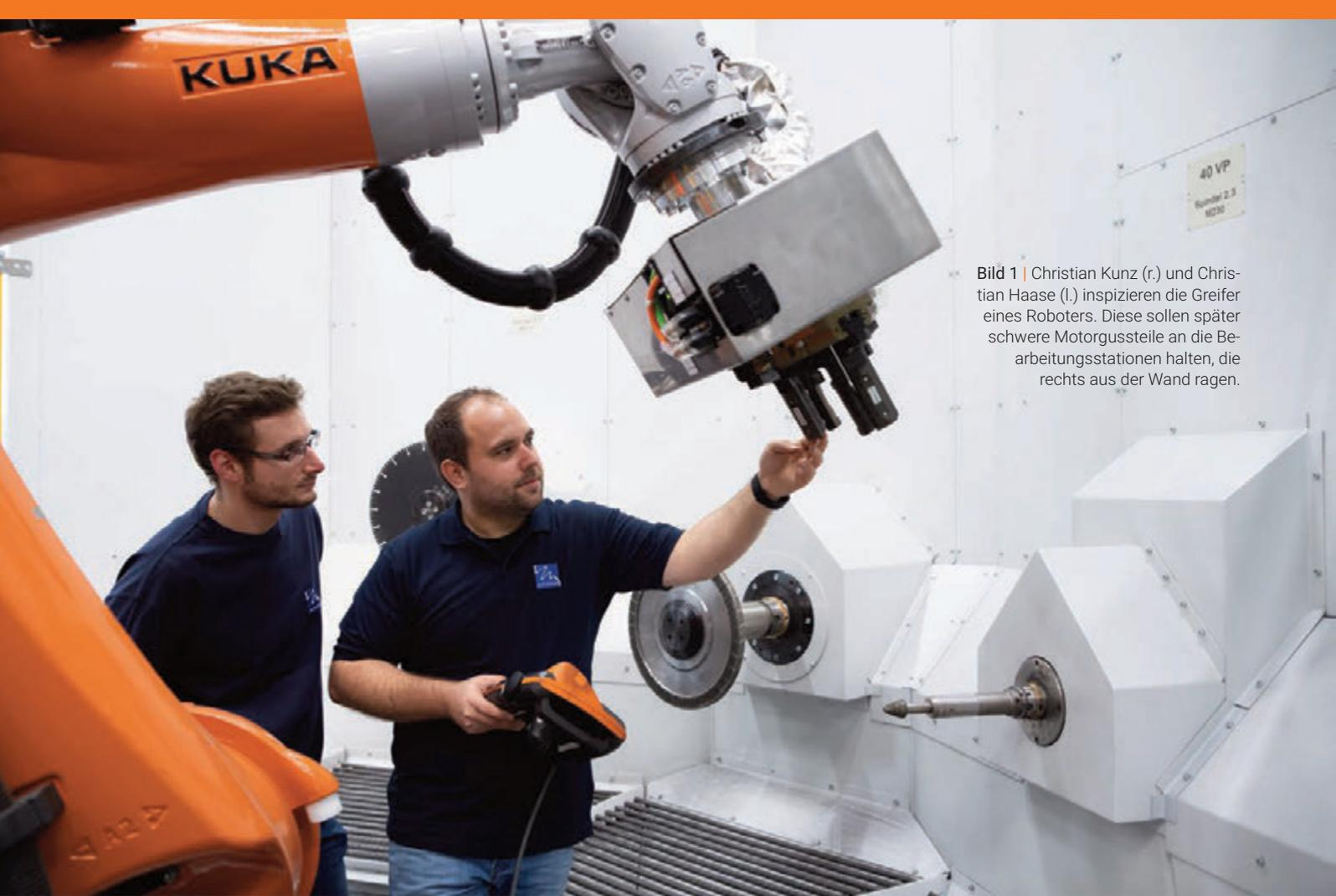
**Bild 1** | Christian Kunz (r.) und Christian Haase (l.) inspizieren die Greifer eines Roboters. Diese sollen später schwere Motorbussteile an die Bearbeitungsstationen halten, die rechts aus der Wand ragen.
