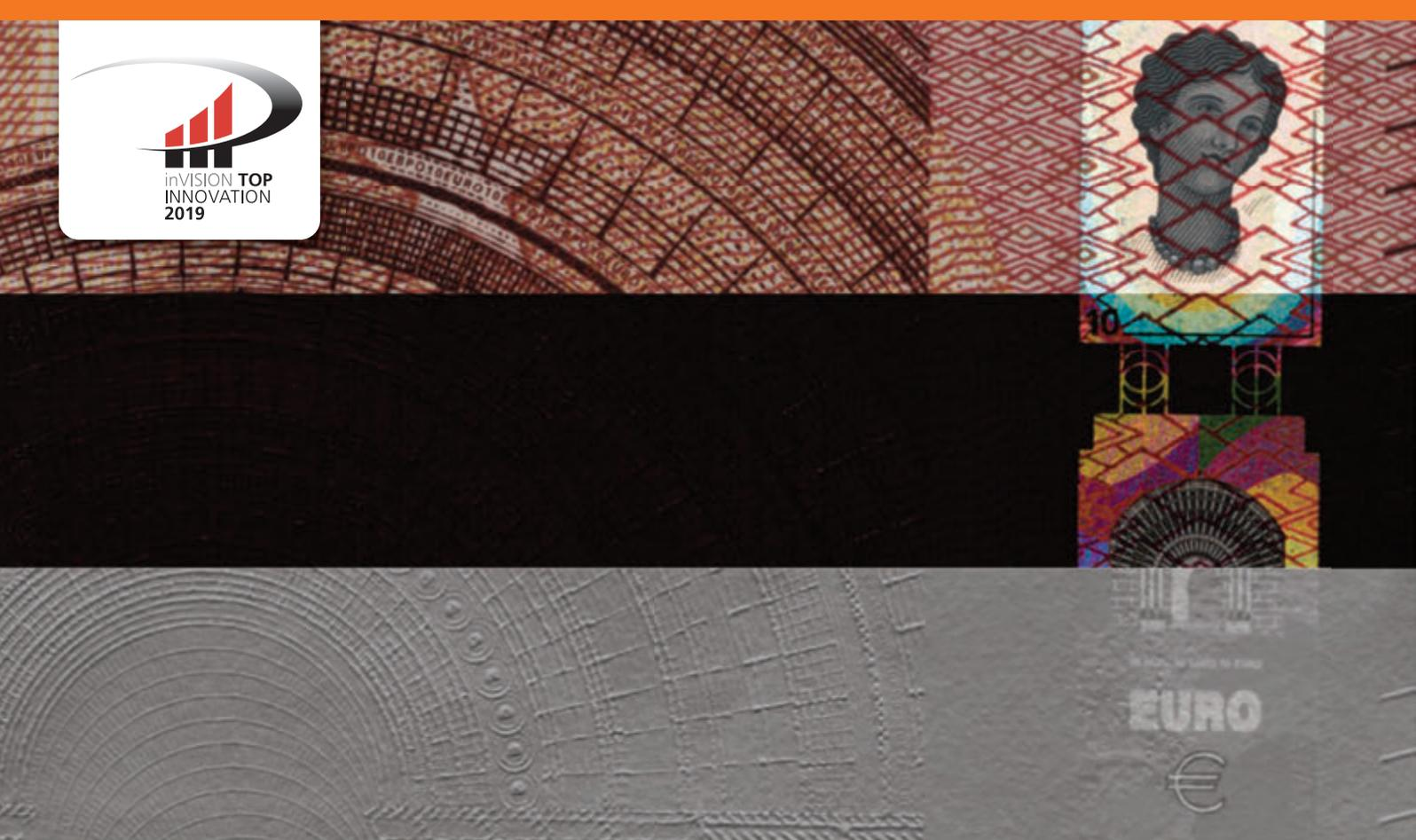
**Bild 1** | Detailausschnitt eines 10-Euro-Scheins, aufgenommen mit einer optischen Auflösung von 20µm/px und einer Inspektionsgeschwindigkeit von bis zu 10m/s: hochauflösendes Farbbild des Druckbilds inklusive Mikrotex (o.); Farbumschlagsbild für Hologramminspektion (m.); Gradientenbild für Tiefdruckelemente (u.).
