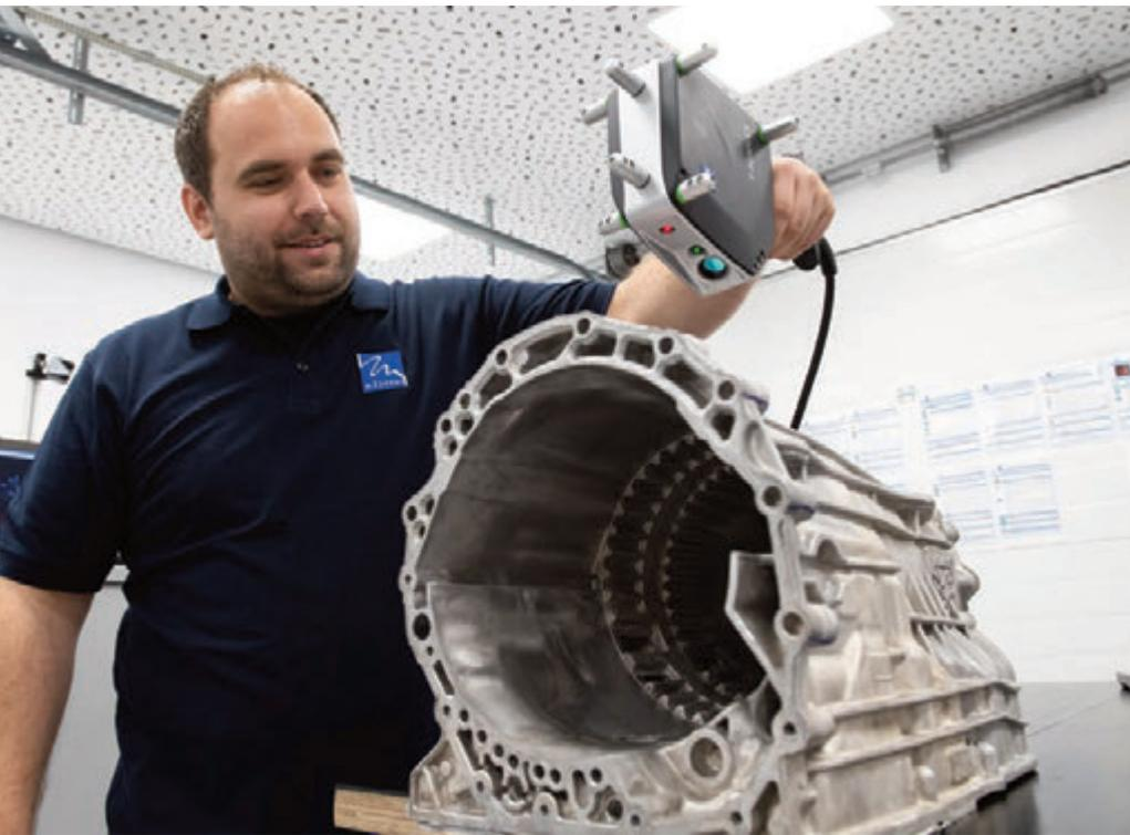
**Bild 3** | Mit dem Zeiss T-Scan liest Christian Kunz die Oberfläche eines Getriebegehäuses ein, auch im Inneren.
