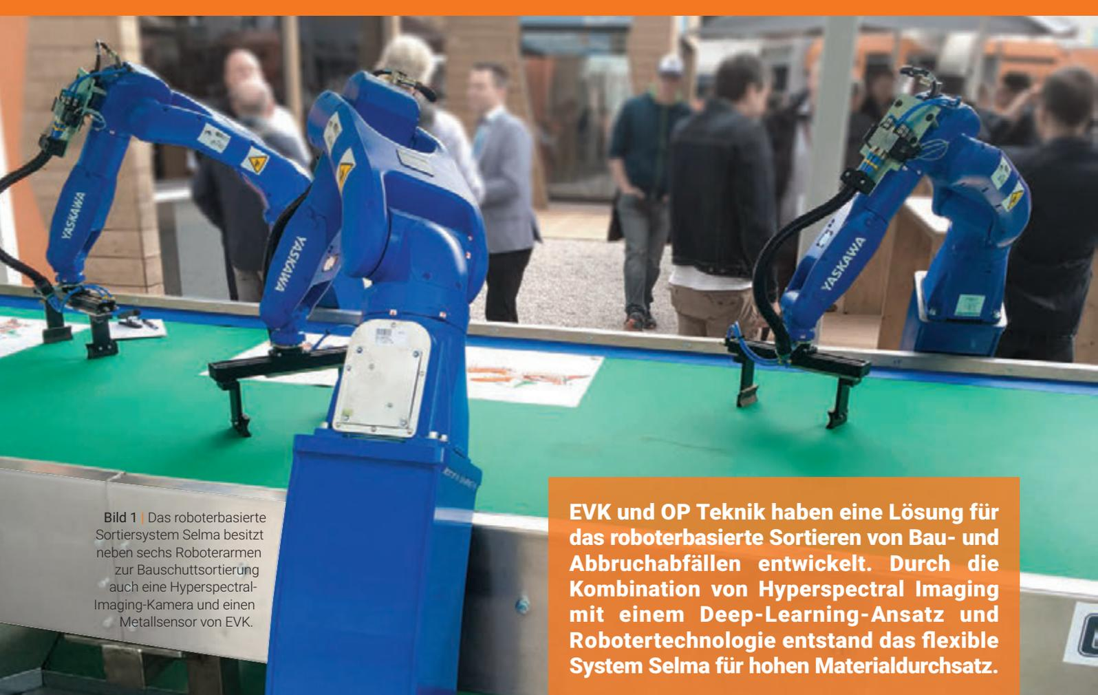
Bild 1 | Das roboterbasierte Sortiersystem Selma besitzt neben sechs Roboterarmen zur Bauschuttsortierung auch eine Hyperspectral-Imaging-Kamera und einen Metallsensor von EVK.
