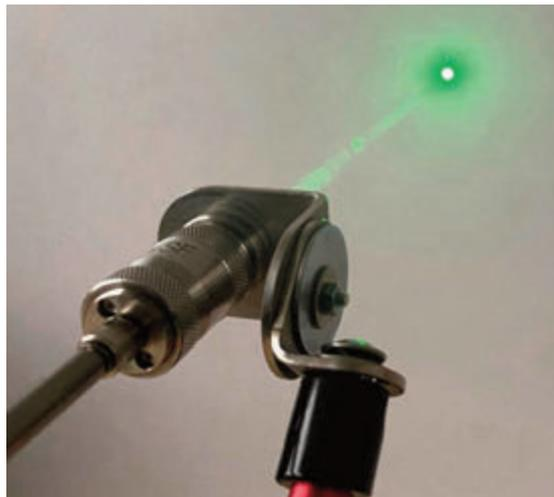
können auch sehr schnelle Prozesse überwacht werden. Das CTratio 2M arbeitet mit einem grünen Visier-Laser bei einer Wellenlänge von 520nm.
