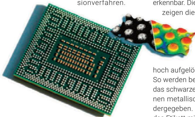
**Bild 3** | Ball Grid Array und ICI 3D-Rekonstruktion (kleines Bild) für einige Lotpunkte: all-in-focus Graustufenbild (l.) und Tiefenmap (r.)
