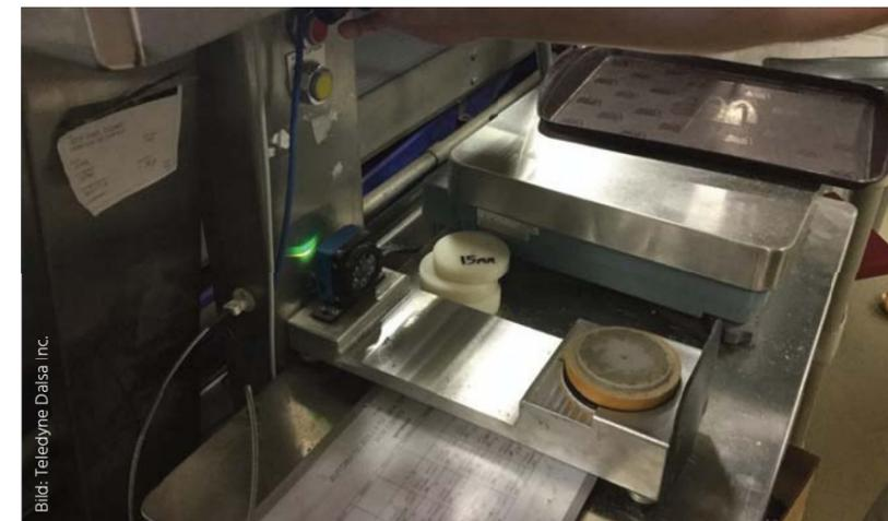
Bild 2 | Nachdem das Brötchen in die Halterung eingesetzt wurde, drückt ein Bediener eine Taste, um die Kamera auszulösen.
