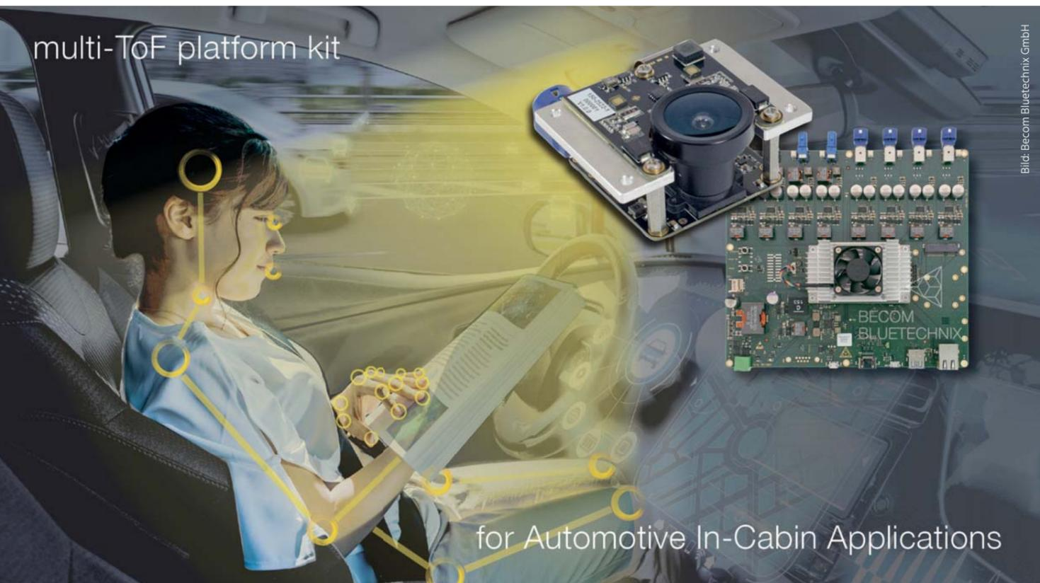
Multi-ToF Frontend mit QVGA ToF-Sensor, 110°FoV, 2m Reichweite und 40fps (links). Daneben der Multi-ToF-Hub mit einem Nvidia-Jetson-TX2-Modul (rechts).
