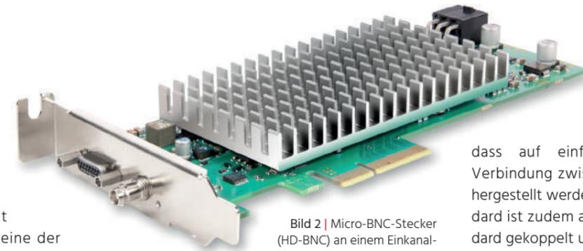
Bild 2 | Micro-BNC-Stecker (HD-BNC) an einem Einkanal-Framegrabber
