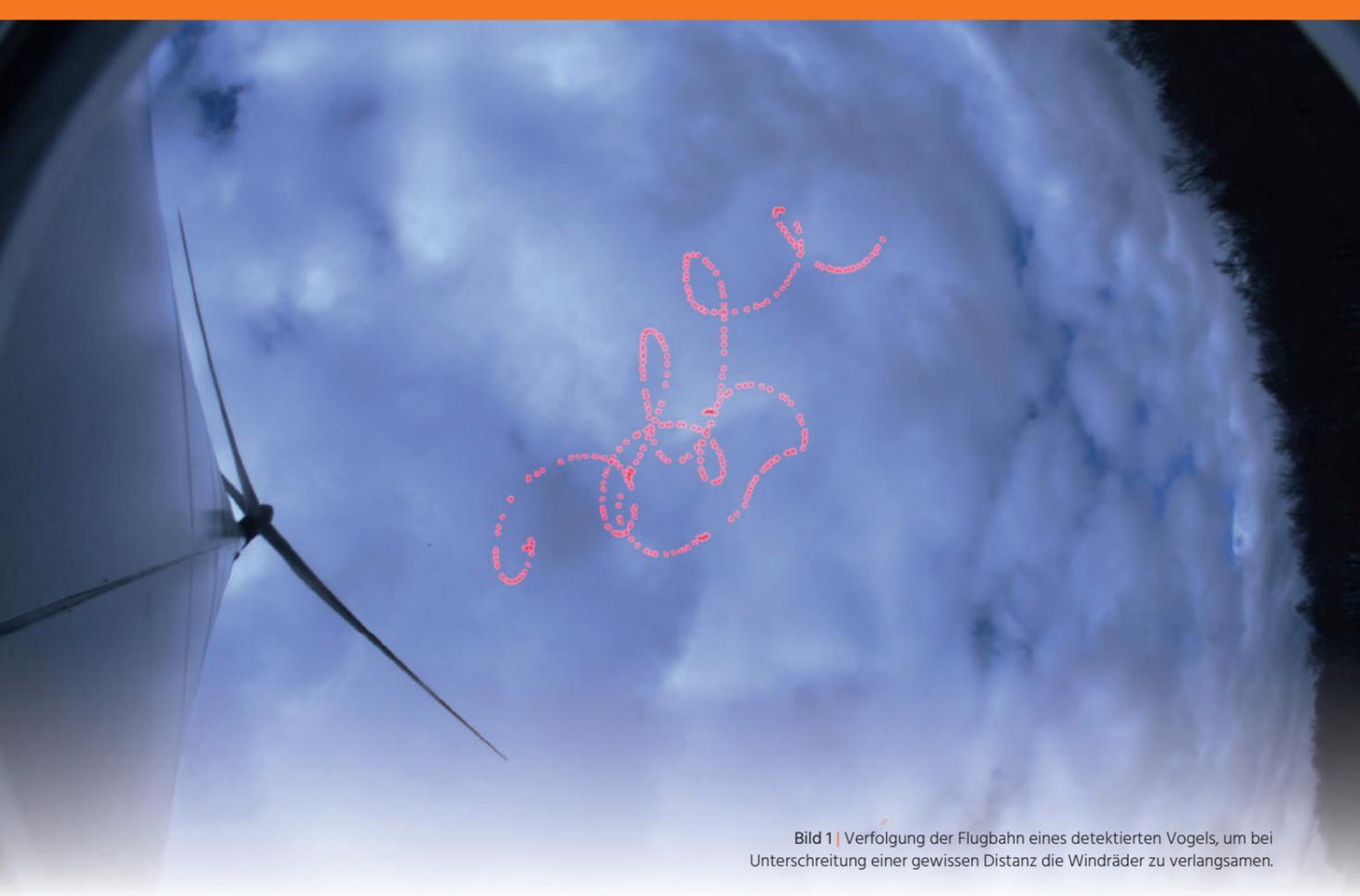
Bild 1 | Verfolgung der Flugbahn eines detektierten Vogels, um bei Unterschreitung einer gewissen Distanz die Windräder zu verlangsamen.
