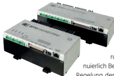
Die LTDVE8CH-20 und LTDVE4CH-20 mit Ethernet- und RS485-Schnittstellen haben acht bzw. vier Ausgabekanäle zur Ansteuerung von gepulsten und kontinuierlich Beleuchtungen, die eine präzise Regelung der Stromstärke, Pulsdauer und Verzögerung von LED-Beleuchtungen ermöglichen. Sie bieten Filteroptionen für Triggersignale und können Strobe-Impulse leicht mit der Kamerabelichtung synchronisieren.
