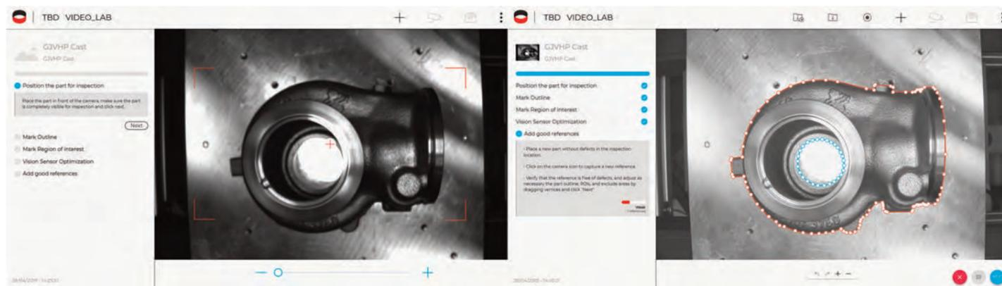
Bild 1 | Produktmustererstellung mit standardmäßigen automatischen Einstellungen einer Industriekamera (l.) und Mustererstellung, nachdem Algorithmen des autonomen Visionsystems Inspekto S70 anhand von Konturmarkierungen des Anwenders die Hardware optimiert haben (r.).
