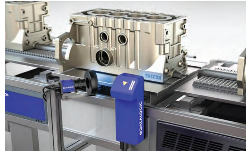
Bild 2 | Der Algorithmus von Advanced OCR erkennt zuverlässig Dotmatrix-Druckbilder, z.B. auf Motorblöcken, Dosen oder Flaschen.
