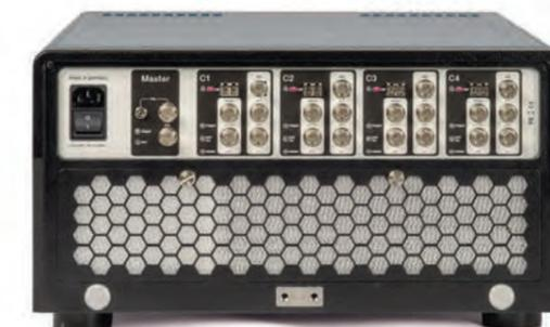
Aktuell profitiert bereits die Bildverstärkerkamera pco.dicam C4 von PCO mit vier CLHS-Kanälen und einer Datenrate von bis zu 4GB/s von dem CLHS-Standard.
