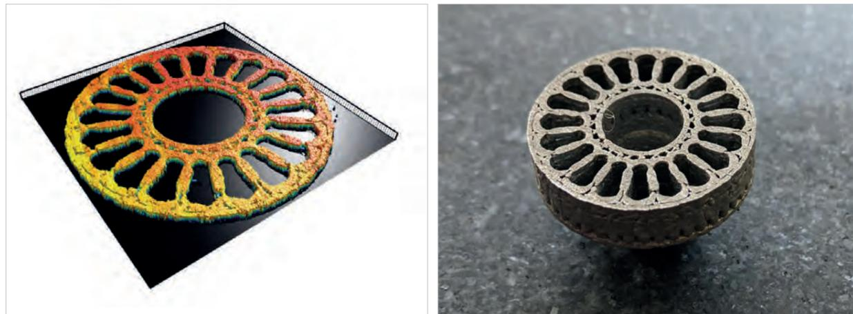
Bilder 1+2 | Mögliche Prozessfehler im 3D-Druck mit dem LPBF-Verfahren führen zu Topographieveränderungen und können mittels OCT gemessen werden. Links: Topographie eines im 3D-Druck generierten Bauteils (r.) das Originalteil.
