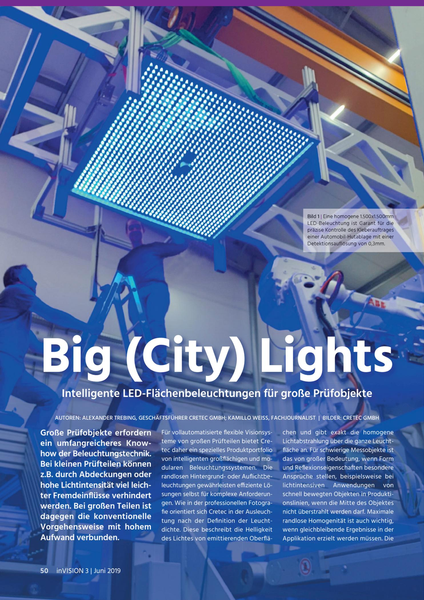
Bild 1 | Eine homogene 1.500x1.500mm LED-Beleuchtung ist Garant für die präzise Kontrolle des Kleberauftrages einer Automobil-Hutablage mit einer Detektionsauflösung von 0,3mm.
