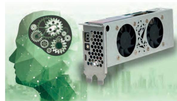
Die FPGA-basierte Beschleunigerkarte Mustang-F100 ist für den Einsatz in industriellen Inferenzsystemen prädestiniert. Die Karte basiert auf der Intel Arria 10 GX1150 FPGA und ist mit 8GB on-board DDR4 RAM ausgestattet. Sie unterstützt eine Vielzahl
