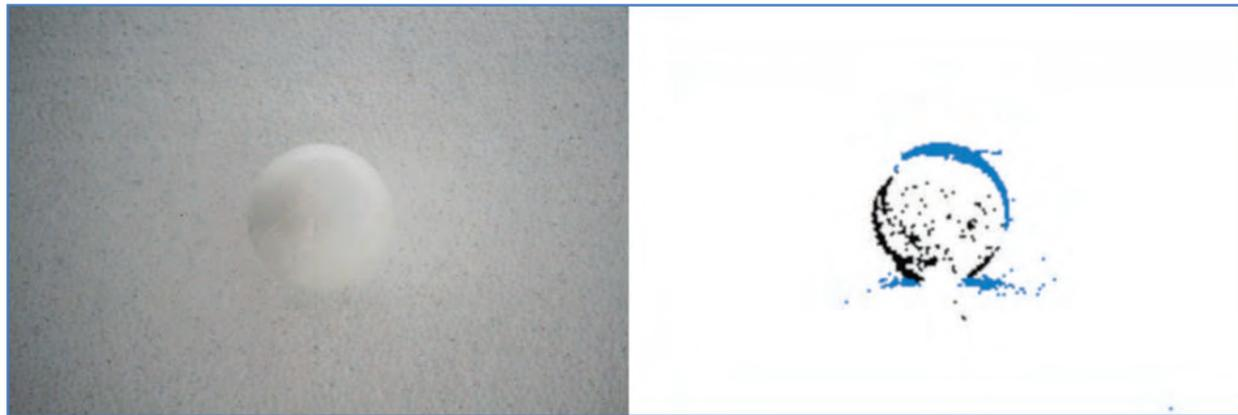
Bild 1 | Anwendungsbeispiel: Bewegliches Objekt auf statischem Hintergrund, aufgezeichnet von einer RGB-Kamera (links) und der VisionCam EB (rechts).
