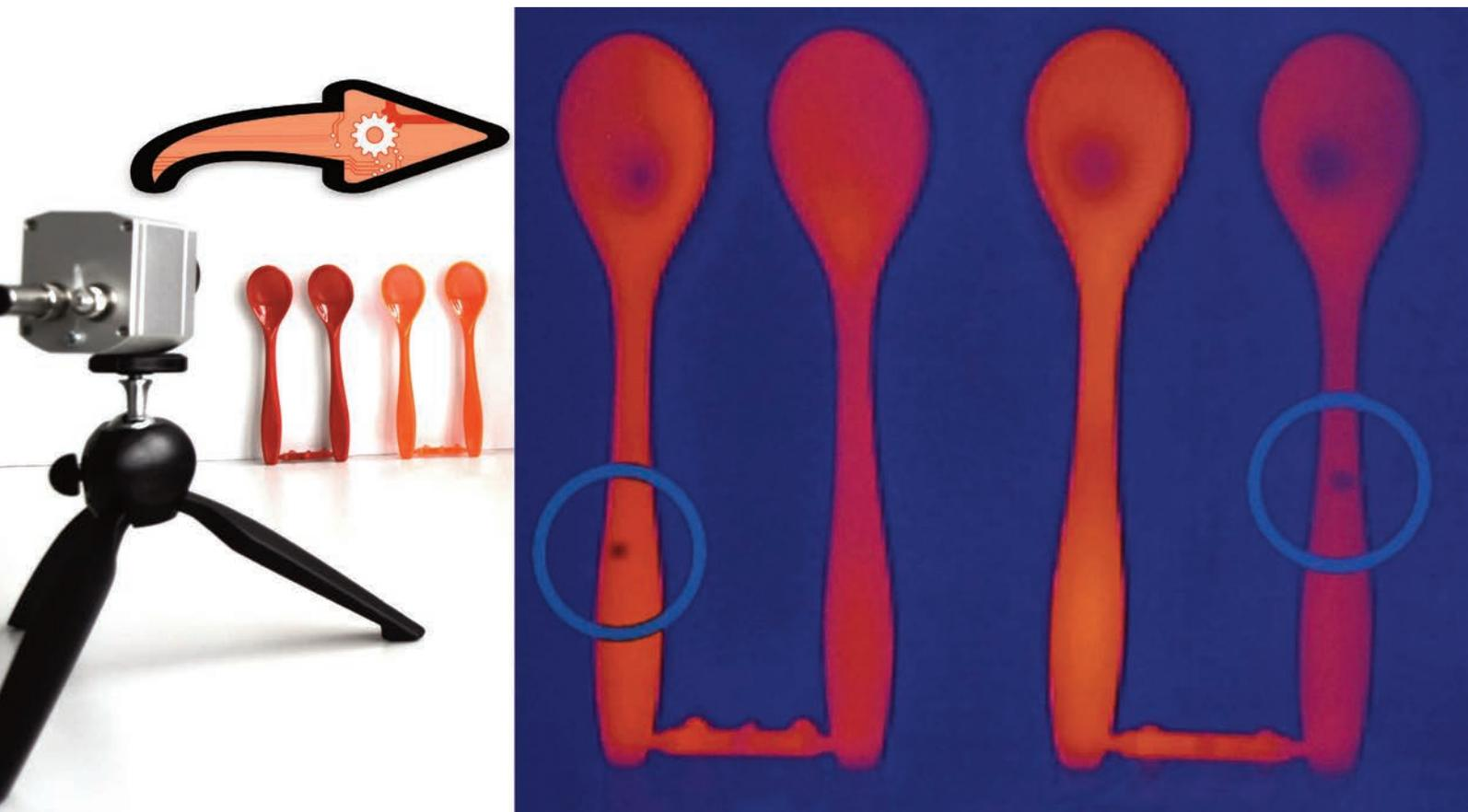
Bild 1 | Die Thermografie kann eine Vielzahl nicht sichtbarer Materialfehler detektieren und visualisieren, so unter anderem bei Spritzgussteilen.
