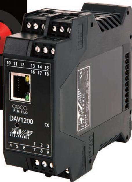
Damit das PWM-Modul DAV1200 mit jeder LED-Beleuchtungssystem- und Kamera-kombination eingesetzt werden kann, lassen sich vier PWM-Frequenzen einstellen, um Interferenzen mit der gewählten Belichtungszeit der Kamera zu vermeiden.
