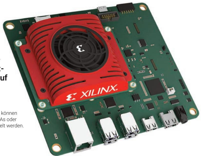
Bild 1 | Mit dem Vision AI Starter-Kit Kria KV260 können Applikation ohne spezielle Kenntnisse über FPGAs oder FPGA-Tools in weniger als einer Stunde entwickelt werden.
