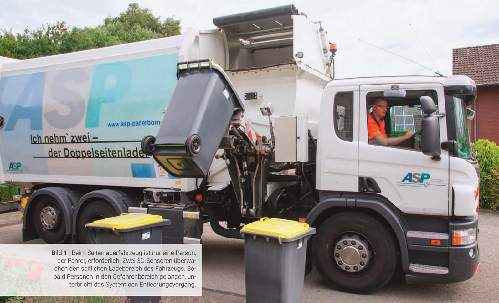
**Bild 1** | Beim Seitenladerfahrzeug ist nur eine Person, der Fahrer, erforderlich. Zwei 3D-Sensoren überwachen den seitlichen Ladebereich des Fahrzeugs. Sobald Personen in den Gefahrenbereich gelangen, unterbricht das System den Entleerungsvorgang.
