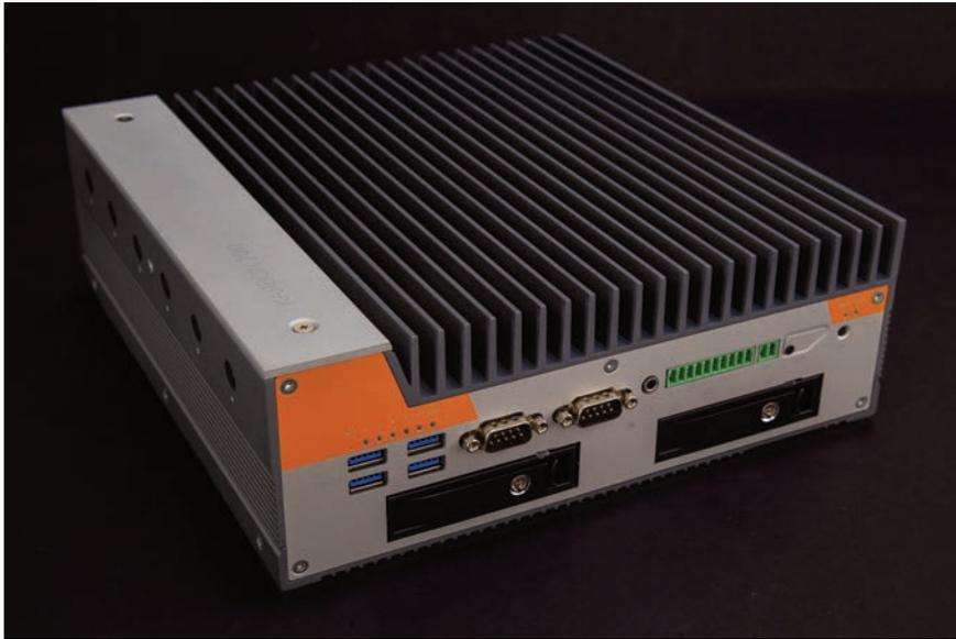
Bild 2 | Der im MowHawk integrierte Rugged IPC Karbon 700-SE von Onlogic ist mit einer 8-Core-Verarbeitung oder einem Xeon-Prozessor und einer GPU ausgestattet.
