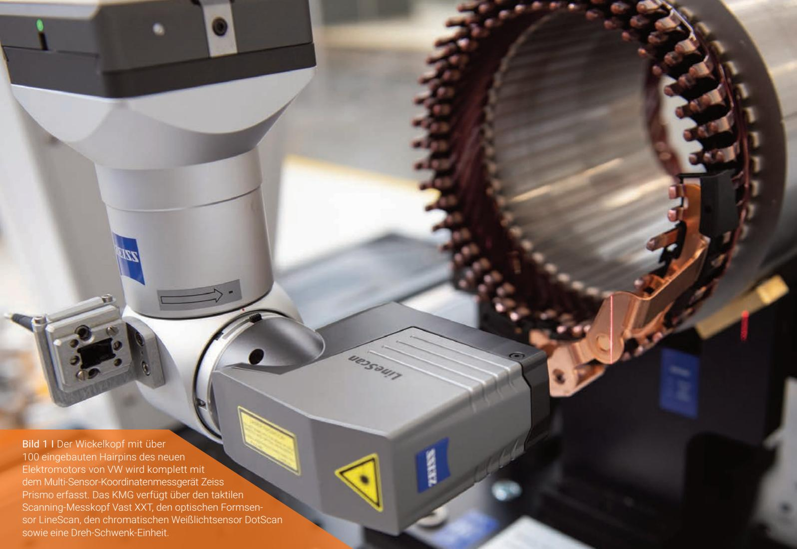
Bild 1 | Der Wickelkopf mit über 100 eingebauten Hairpins des neuen Elektromotors von VW wird komplett mit dem Multi-Sensor-Koordinatenmessgerät Zeiss Prismo erfasst. Das KMG verfügt über den taktilen Scanning-Messkopf Vast XXT, den optischen Formsensoren LineScan, den chromatischen Weißlichtsensor DotScan sowie eine Dreh-Schwenk-Einheit.
