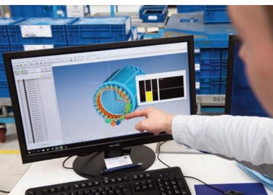
**Bild 3** | Durch eine Falschfarbendarstellung wird die Abweichung vom CAD-Modell visualisiert.
