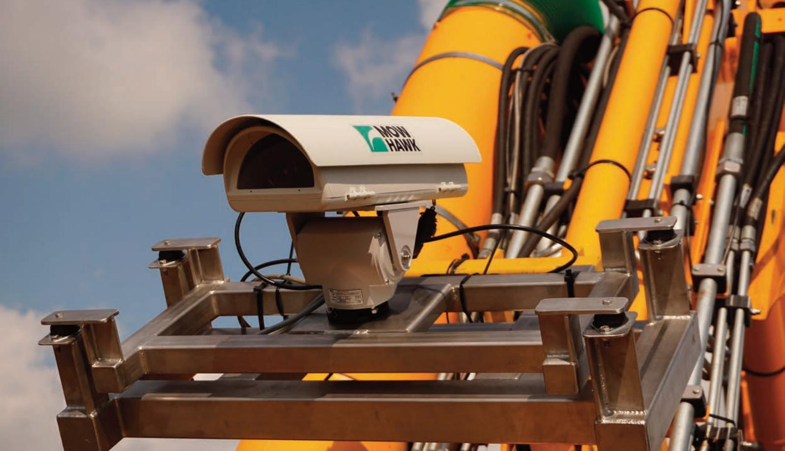
Bild 1 | Das MowHawk Smart Mower Vision-System ist ein intelligentes Kamerasystem am Mähbalken eines Randstreifenmähers. Er sorgt dafür, dass invasive Pflanzen nicht auf dem Komposthaufen landen, wo sie sich ausbreiten können.
