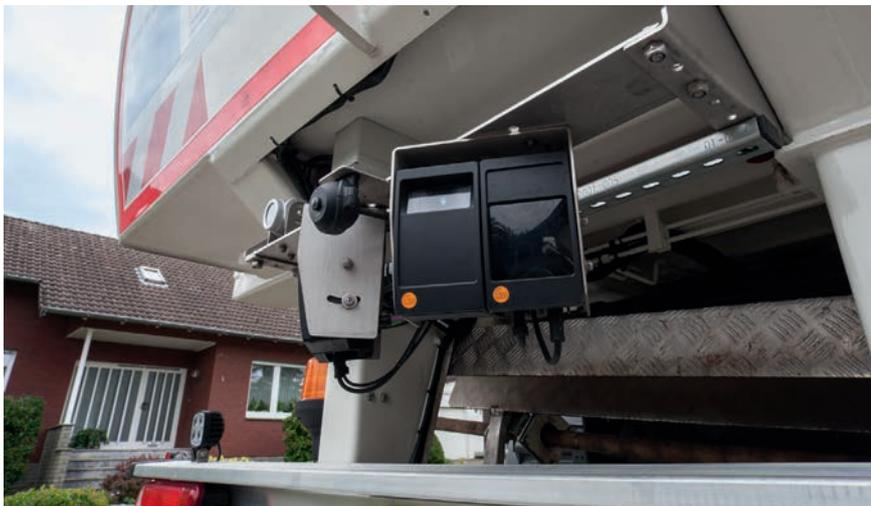
**Bild 2** | Auch Bei Rückwärtsfahren überwachen 3D-Sensoren den Rückraum und stoppen das Fahrzeug selbständig bei Kollisionsgefahr.
