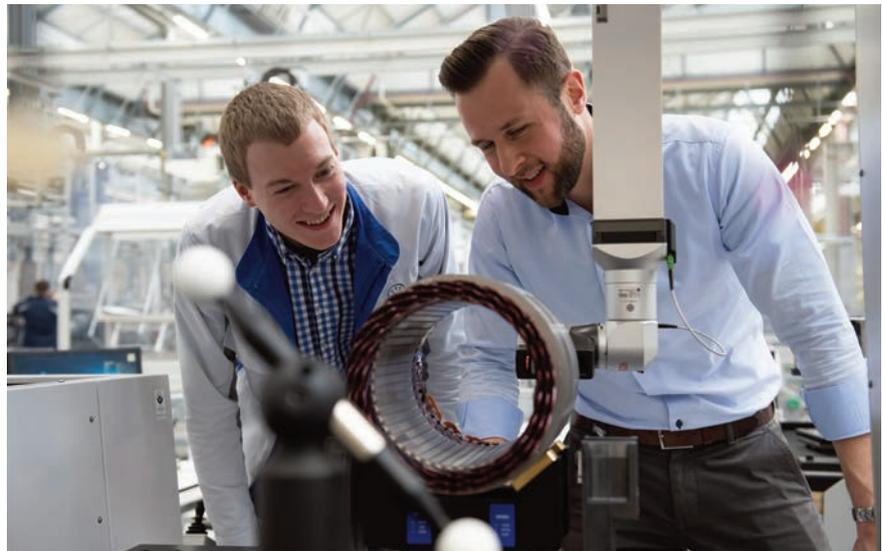
**Bild 2** | Der fertig montierte Stator wird auf einer Vorrichtung von Zeiss reproduzierbar fixiert.
