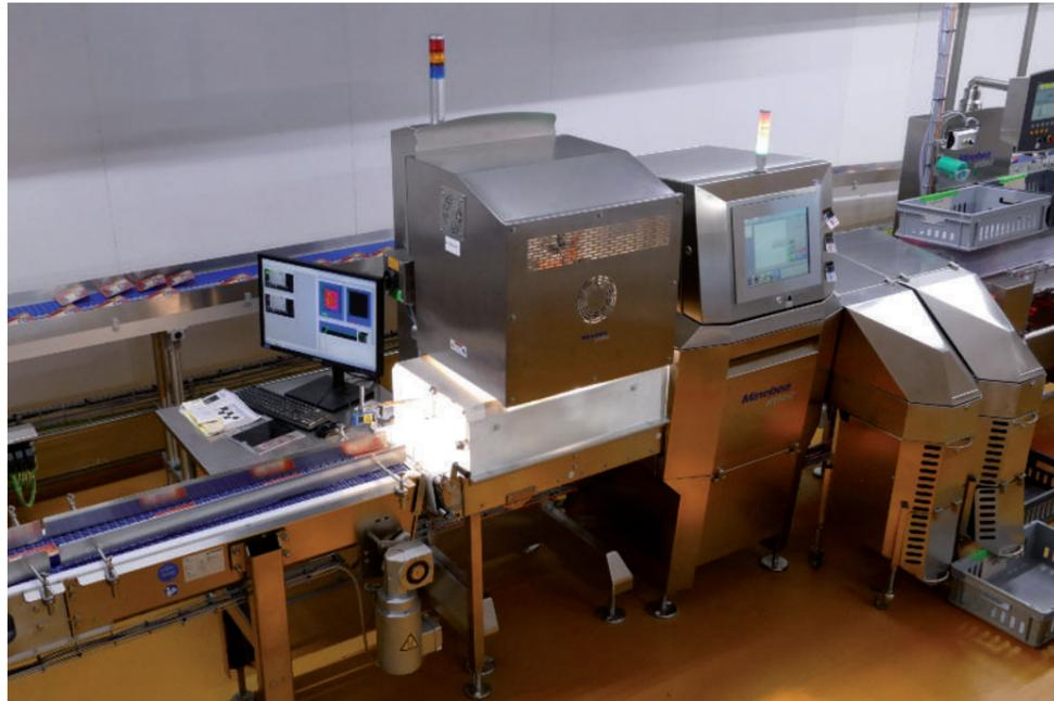
Bild 2 | Von links laufen die Käseverpackungen zur Prüfung durch das Hyperspektral- und das direkt anschließende Röntgensystem.
