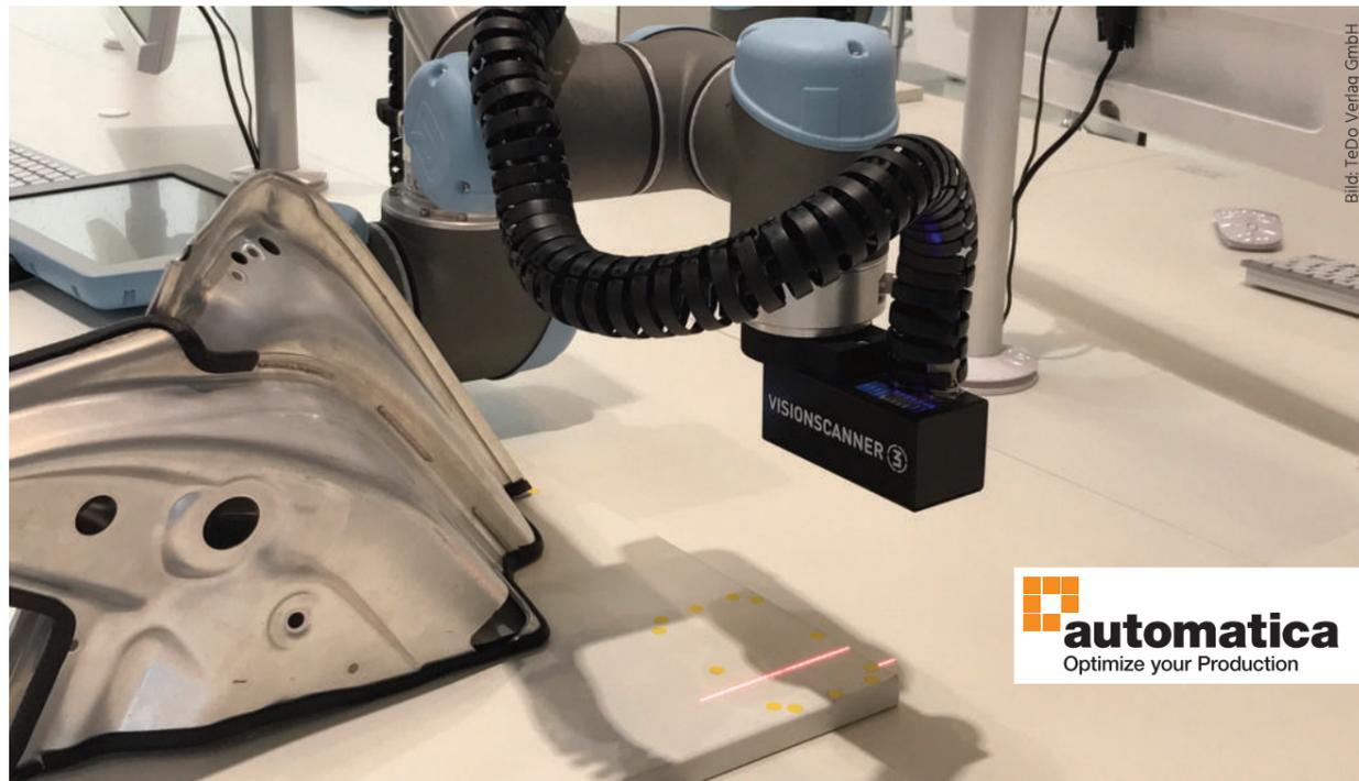
Bild 1 | Der Visionscanner 3 von EngRoTec ist in Verbindung mit der Software Visionelements 3 speziell zur 6D-Roboterführung ausgelegt.
