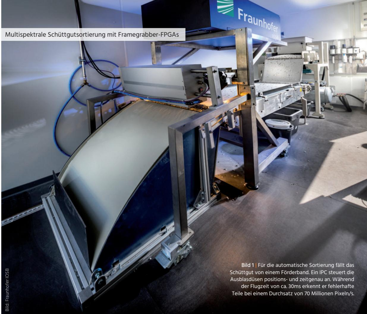
Bild 1 | Für die automatische Sortierung fällt das Schüttgut von einem Förderband. Ein IPC steuert die Ausblasdüsen positions- und zeitgenau an. Während der Flugzeit von ca. 30ms erkennt er fehlerhafte Teile bei einem Durchsatz von 70 Millionen Pixeln/s.
