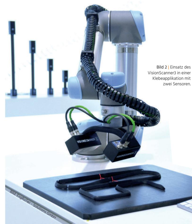
Bild 2 | Einsatz des VisionScanner3 in einer Klebeapplikation mit zwei Sensoren.
