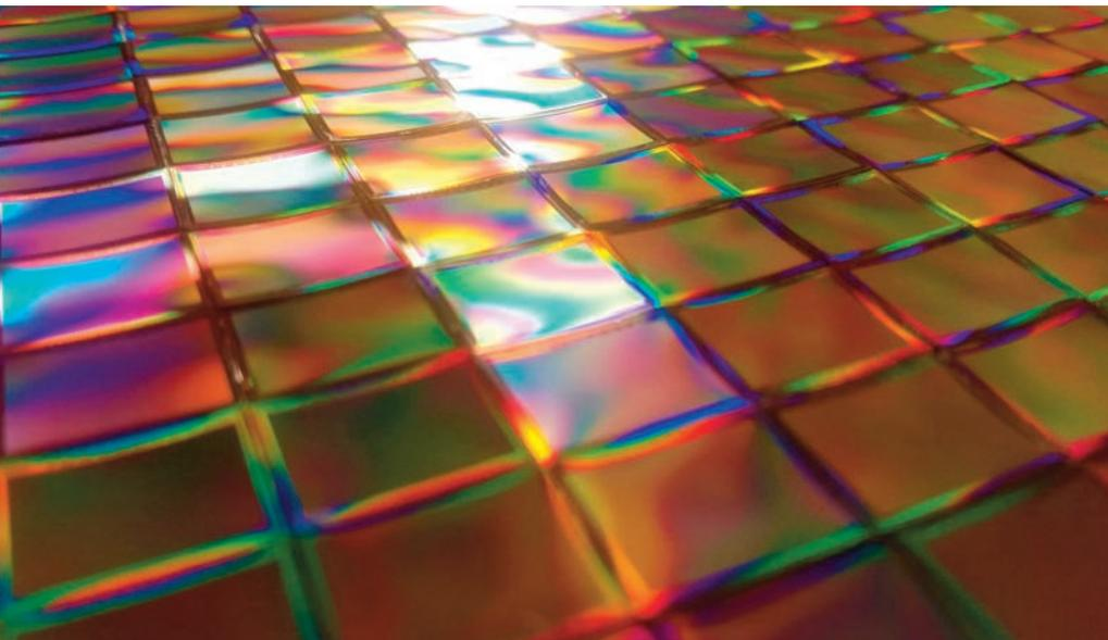
**Das Startup Silina hat eine neue Technologie entwickelt, mit der Hunderte von Bildsensoren gleichzeitig gekrümmt werden können. Dies bietet eine völlig neue Perspektive für das Kameradesign, von der Massenproduktion bis hin zu Nischenmärkten.**
