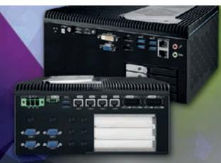
Das KI-Computersystem ECX-2600 PEG von Vecow (Vertrieb Plug-In Electronic) lässt sich mit Nvidia Grafikkarten kombinieren und misst schlanke 260x240x123mm. Es unterstützt Intel Xeon und Core i9 / i7 / i5 / i3-Prozessoren der 10. Generation (Comet Lake) mit bis zu zehn Kernen. Zudem
