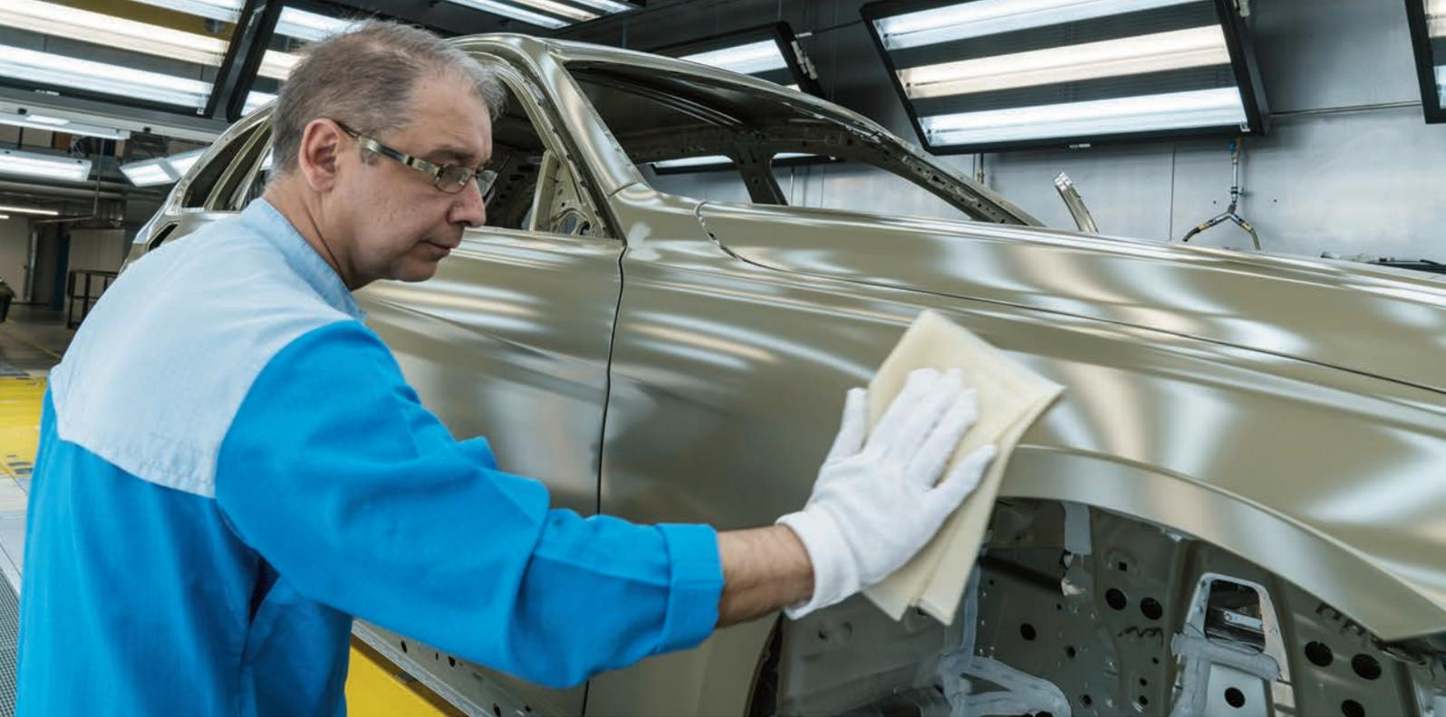
Bild 1 | Die Qualität der kathodischen Tauchlackierung (E-Coat) ist essentiell für einen perfekten Klarlack (C-Coat). Mit dem mobilen Rhopoint Tams ist mittels Phasenmessender Defektometrie (PMD) innerhalb weniger Sekunden die Analyse relativ großer Bereiche möglich.
