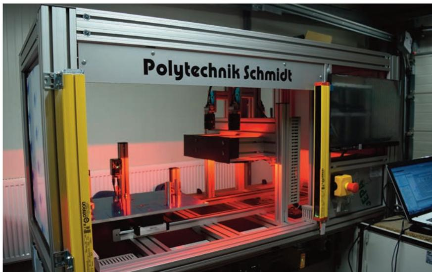
**Bild 2** | Drei Genie Nano-Kameras von Teledyne Dalsa scannen die Prüfteile, die von speziellen Dombeleuchtungen beleuchtet werden.
