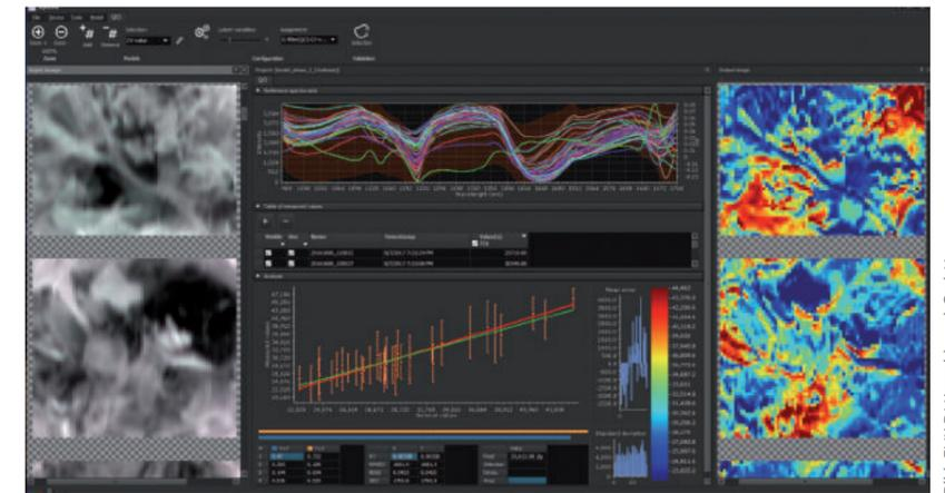
Bild 2 | Quantitative Heizwertmessung am Schüttgut: HSI-Eingangsbilder (links); Referenzspektrensätze, Featurekurve für die Heizwert-Messung in grün, Messwerttabelle, Kalibrationslinie mit Datenpunkten, sowie statistische Qualitätsparameter (Mitte); Ausgangsbildern (rechts).
