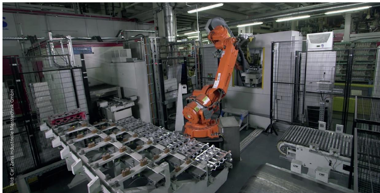
Ein Roboter nimmt einen Zylinderkopf auf, um den Computertomographen VoluMax direkt in der Linie damit zu bestücken.
