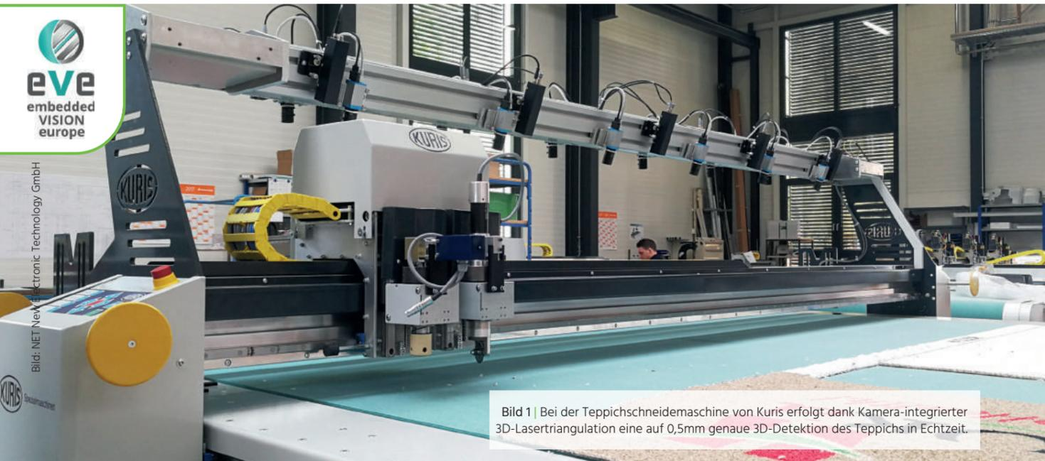
Bild 1 | Bei der Teppichschneidemaschine von Kuris erfolgt dank Kamera-integrierter 3D-Lasertriangulation eine auf 0,5mm genaue 3D-Detektion des Teppichs in Echtzeit.
