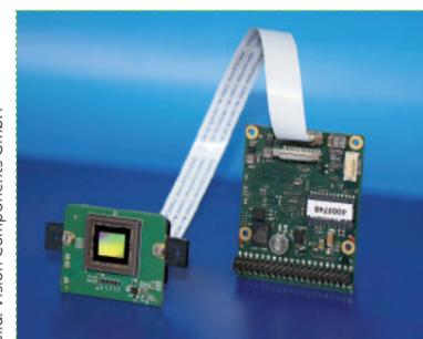
Die Embedded-Vision-Systeme der Serie VC Z sind wahlweise mit eigenem Standard- oder IP67-Schutzgehäuse sowie in Platinen-Ausführungen erhältlich.
