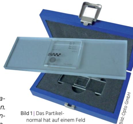
Bild 1 | Das Partikelnormal hat auf einem Feld von  $50 \times 50\text{mm}$  klar definierte Formen und Musterpartikel.
