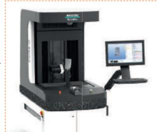
Der Arbeitsabstand von 80mm und der Messbereich von +/- 3mm sind auch bei der neuen Sensorgeneration gegeben.
