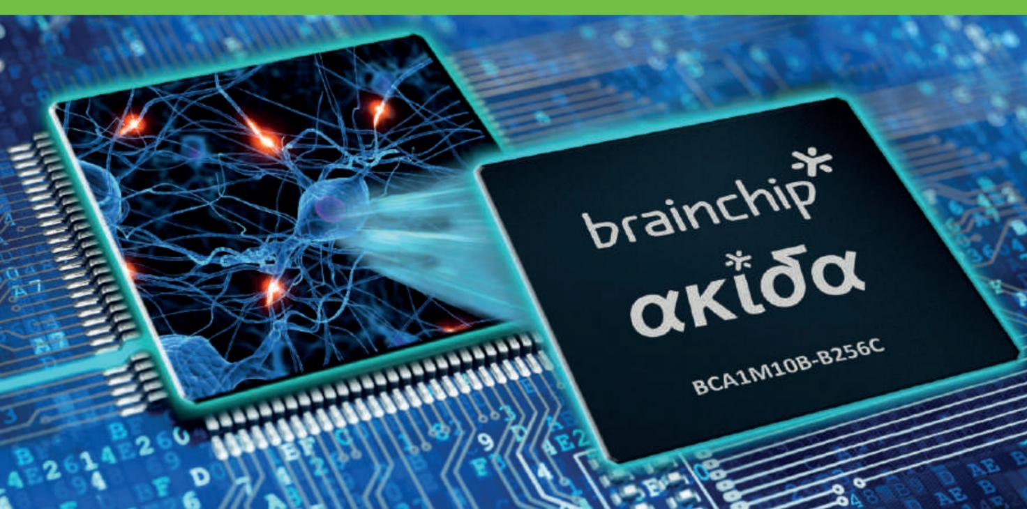
Bild 1 | Jeder Akida NSoC weist 1,2Mio. Neuronen und 10Mrd. Synapsen auf, was eine 100x bessere Effizienz mit sich bringt, als bei neuromorphen Testchips von Intel und IBM. Der NSoC wurde für den Einsatz als eigenständiger Embedded-Beschleuniger oder Co-Prozessor entwickelt.
