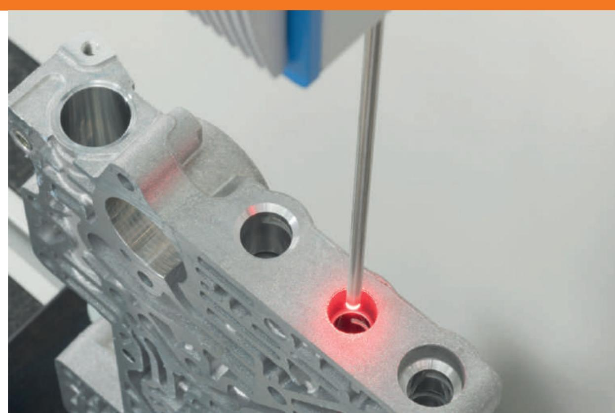
Der Innenprüfsensor IPS B5 taucht in kleine Bohrungen ab 5mm ein und prüft deren Oberflächen.
