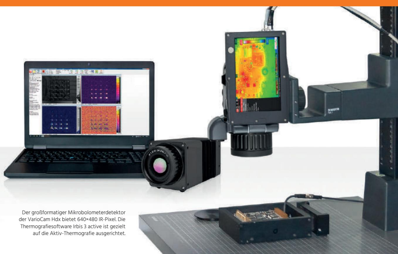
Der großformatiger Mikrobolometerdetektor der VarioCam Hdx bietet 640x480 IR-Pixel. Die Thermografiesoftware Irbis 3 active ist gezielt auf die Aktiv-Thermografie ausgerichtet.
