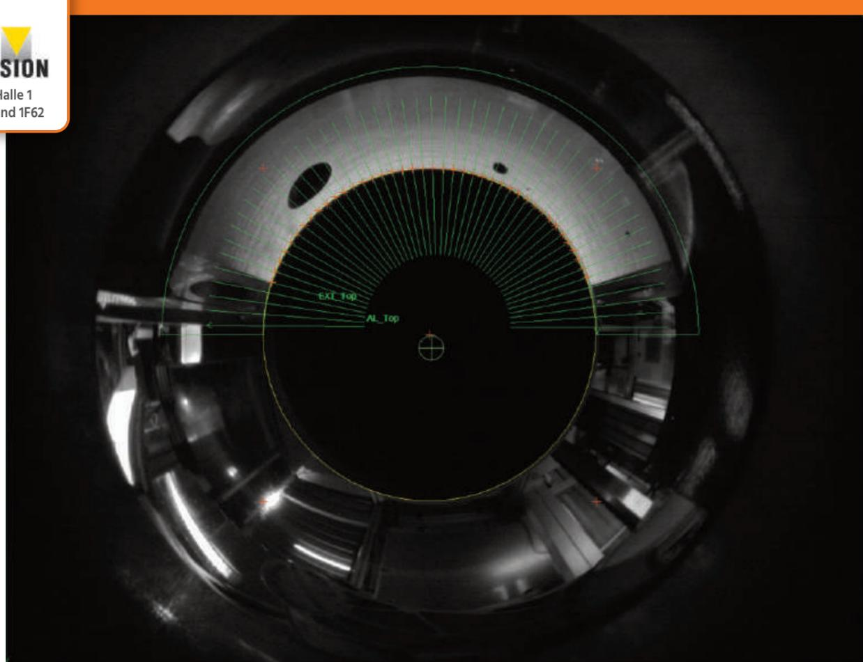
Halbkreisförmige Lagerschale mit Defekten (schwarze Lunker) während der Bildvorverarbeitung.
