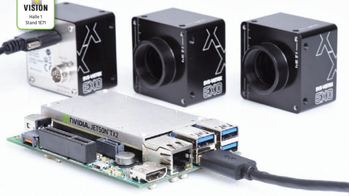
Mit einem GenCam GenTL-Treiber kann auch auf einem SoC mit dem Nvidia Jetson eine hervorragende Leistung im Bildeinzug bereitgestellt werden.
