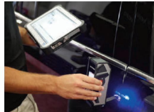
ladbarem Akku und Tablet-PC erfolgt über eine sichere WLAN-Verbindung. Die gemessenen Dimensionen werden am Sensor als Zahlenwerte und mit einer Profilkurve am Tablet-PC angezeigt.
