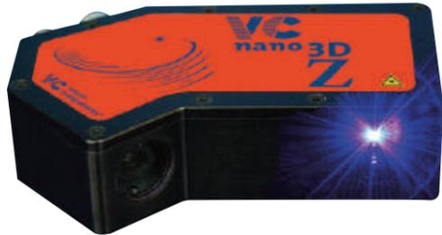
Die Embedded 3D-Lasersensoren der Baureihe VCnano3D-Z nutzen ein Zynq-SoC von Xilinx, das einen Dual-Core-ARM-Prozessor mit einem FPGA kombiniert. Die Profilsensoren bieten Scanraten bis 2kHz und haben eine Ethernet-Schnittstelle. Das System setzt einen blauen 450nm-Laser der Klasse 2 ein. Dank Ambient Light Suppression Technology kann es bei Um-
