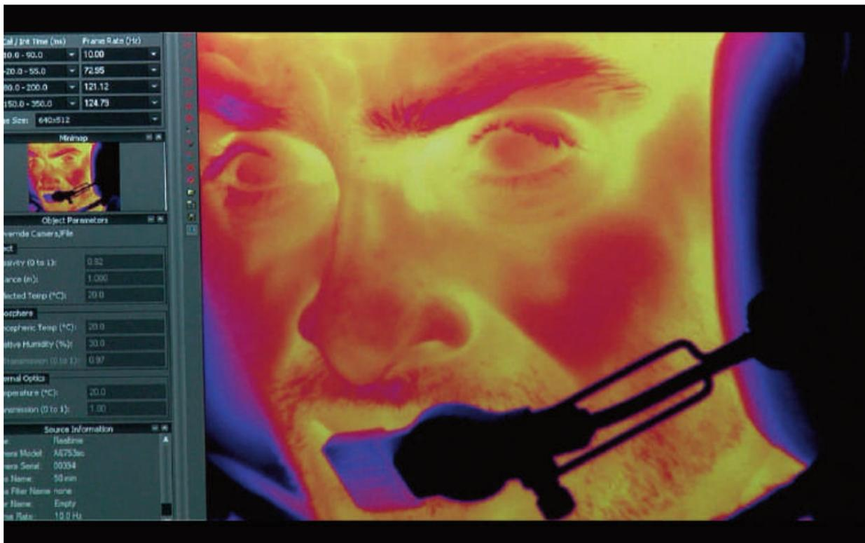
Die Wärmebildkamera A6750sc überwacht die Gesichtstemperaturmodulation der Hubschrauber-Crew, während diese typische Pilotenaufgaben ausführt. Die Kamera erfasst selbst kleinste Temperaturunterschiede, die in Verbindung mit menschlichen Emotionen wie Stress auftreten.
