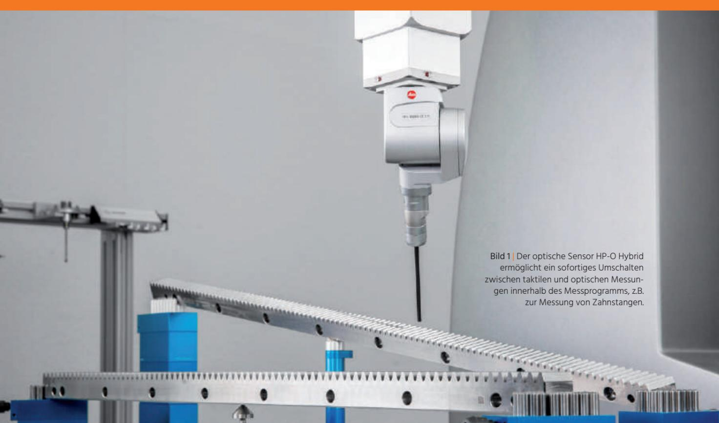
Bild 1 | Der optische Sensor HP-O Hybrid ermöglicht ein sofortiges Umschalten zwischen taktilen und optischen Messungen innerhalb des Messprogramms, z.B. zur Messung von Zahnstangen.
