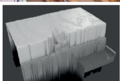
Bild 1+2 | Die DA-MI-KA (Dachdiagnose mittels Kamertechnik) ermöglicht eine automatisierte Inspektion von Dachaufbauten von Zugfahrzeugen per optischer Kontrolle. Im kleinen Bild ist das Rendering einer Schleifleiste mit Loch.
