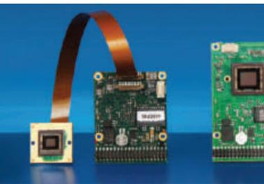
Die intelligenten Kameras des Typs VCSBC nano Z-RH-0273 bieten ein exzellentes Preis-Leistungs-Verhältnis für Applikationen, die bei mittleren Auflösungen hohe Geschwindigkeiten erfordern. Ihr IMX273-Sensor aus der Pregius-Baureihe hat eine Auflösung von 1,6MP. Die maximale Bildrate beträgt in diesem Format
