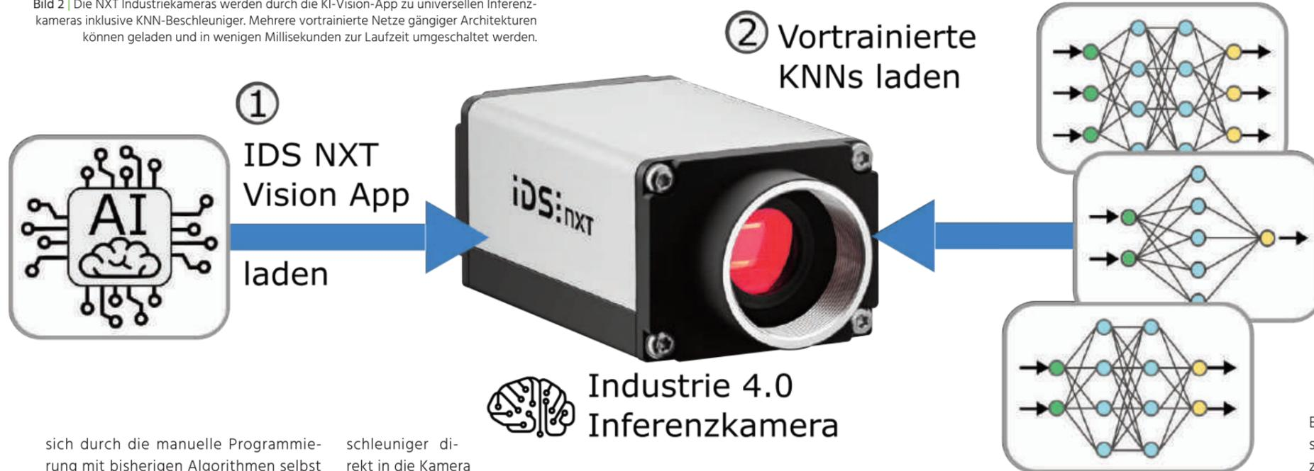
Anomalien erkennen, Früchte klassifizieren, Oberflächen prüfen, Leiterplatten und deren Bestückung verifizieren, usw. Die flexible Anpassungsfähigkeit der NXT-Plattform vereinfacht deren Integration in ein bestehendes System und die Anpassung an verschiedene Aufgaben.
