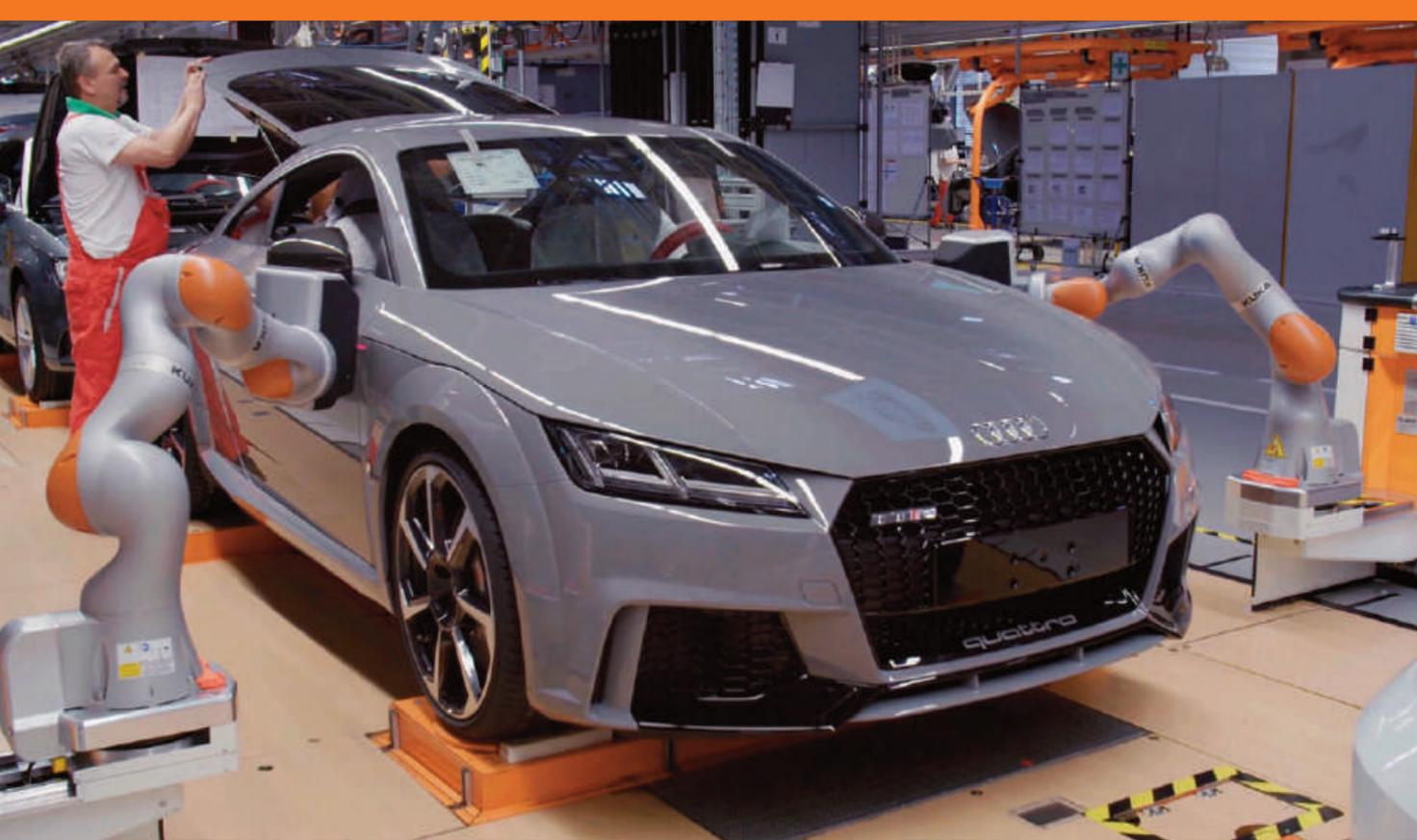
Der Calipri C12 Cobot sorgt für eine hochqualitative Passform und Verarbeitung bei der Inline-Endmontage des Audi TT.
