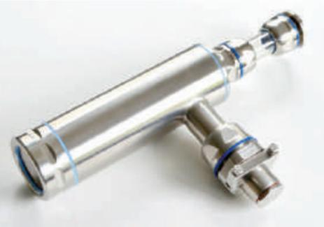
Das Angebot an Dolphin-Kameraschutzgehäusen für hygienische Anforderungen wurde ausgebaut. Mit drei verschiedenen Formaten bieten die Modelle Kompakt-kameras bis 218mm Länge mit Querschnitten von 29x47mm bis 40x40mm Platz. Die Gehäuse entsprechen den EHEDG-Richtlinien und haben elektropolierte Gehäuseoberflächen aus V4A-Edelstahl AISI 316L mit Rautiefen unter 0,8µm. Sämtliche Dichtungen und Schläuche
