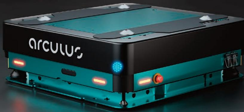
Bild 1 | Arculee heißen die intelligenten Transport-Roboter von Arculus. Sie bringen Technologien selbstfahrender Autos in moderne Fertigungshallen.
