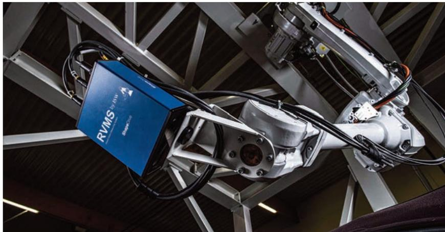
**Bild 2** | Der 3D ShapeDrive MLBS Sensor von Wenglor Sensoric leuchtet die Messpunkte per Streifenlichtprojektion aus und misst damit auf Bruchteile eines Mikrometers genau.
