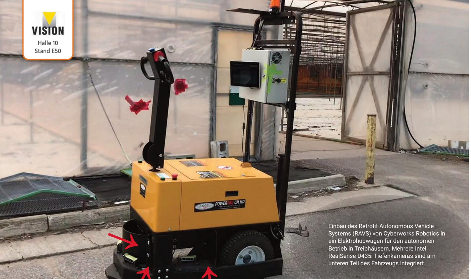
Einbau des Retrofit Autonomous Vehicle Systems (RAVS) von Cyberworks Robotics in ein Elektrohubwagen für den autonomen Betrieb in Treibhäusern. Mehrere Intel RealSense D435i Tiefenkameras sind am unteren Teil des Fahrzeugs integriert.
