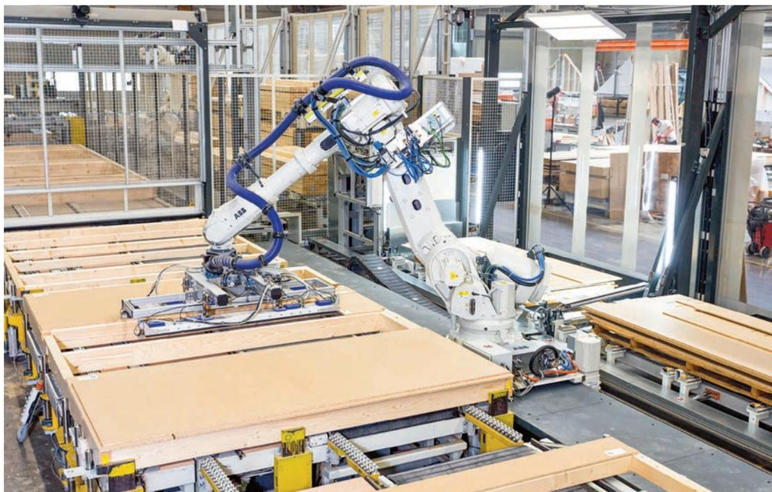
**Bild 1 |** Die 3D-Kamerasysteme erkennen die jeweilige Plattenposition der Holzwerkstoff- oder Gipskartonbauplatten. Die exakten Positionsdaten werden verarbeitet und an einen Roboter übergeben, der dann die präzise Beplankung übernimmt.
