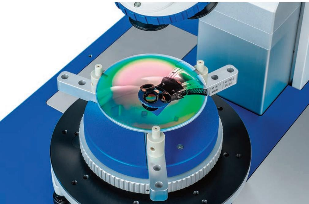
**Das OptiCentric 101 IR System von Trioptics dient zur Prüfung und Montage von Infrarot-Objektiven unter Verwendung von visuellen sowie mittel- und langwelligen infraroten Prüfwellenlängen. Dabei bietet es eine hohe Genauigkeit von  $\leq 0,25\mu\text{m}$  für Messungen im IR-Spektralbereich.**
