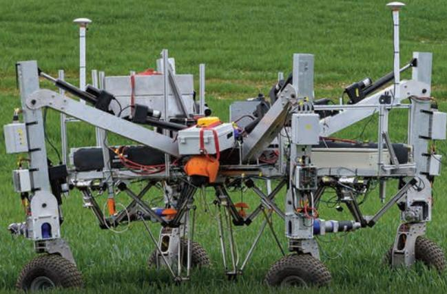
**Bild 1** | 'Dick' ist ein Unkrautbekämpfungsroboter mit Such- und Bekämpfungsfunktion. Der Roboter entfernt mit einem Zapper das vorher per KI identifizierte Unkraut
