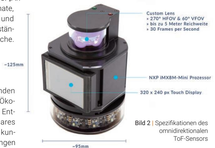
**Bild 2** | Spezifikationen des omnidirektionalen ToF-Sensors
