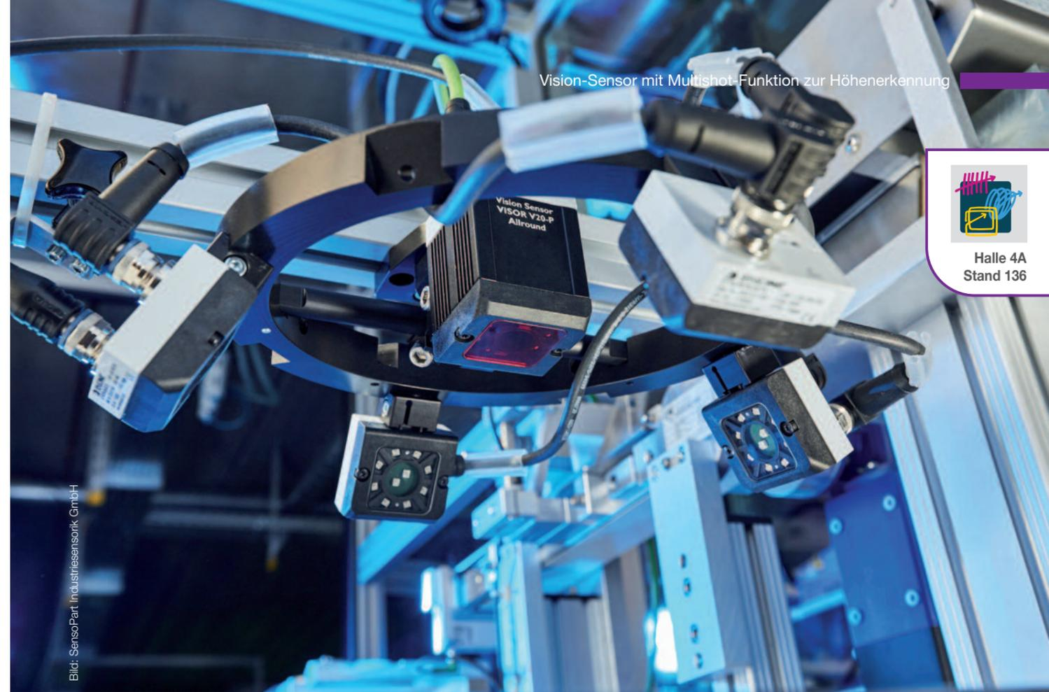
Vision-Sensor mit Multishot-Funktion zur Höhenerkennung
