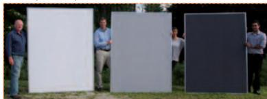
Die Beschichtung ist auch auf komplexe Formen aufsprühbar und in unterschiedlichen Reflektivitätsstufen erhältlich.
