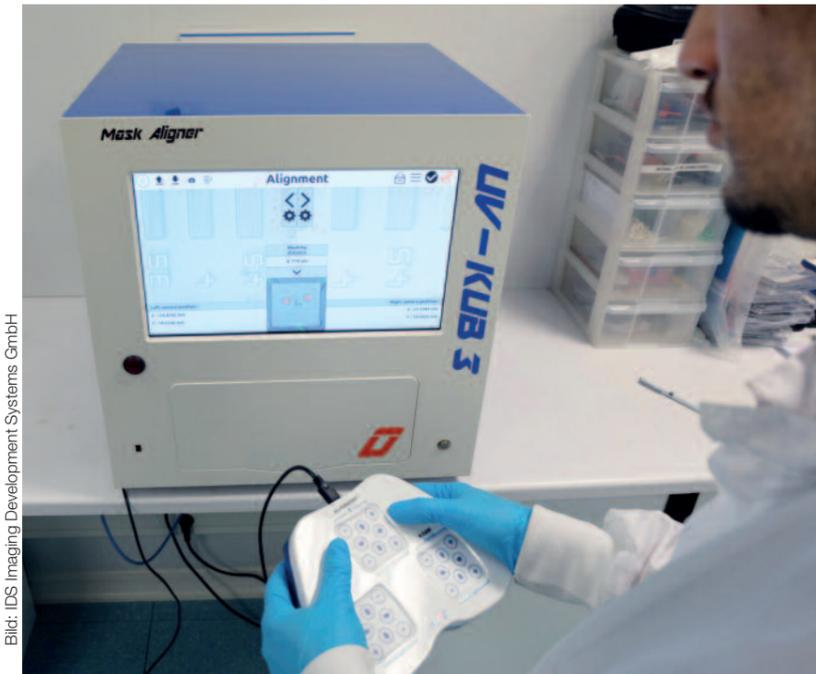
Bild 2 | Im Maskenbelichter UV-KUB3 sind zwei Platinenkameras eingebaut, welche die Ausrichtung der Positionierungsmarken mit einer Genauigkeit <math><2\mu\text{m}</math> ermöglichen.
