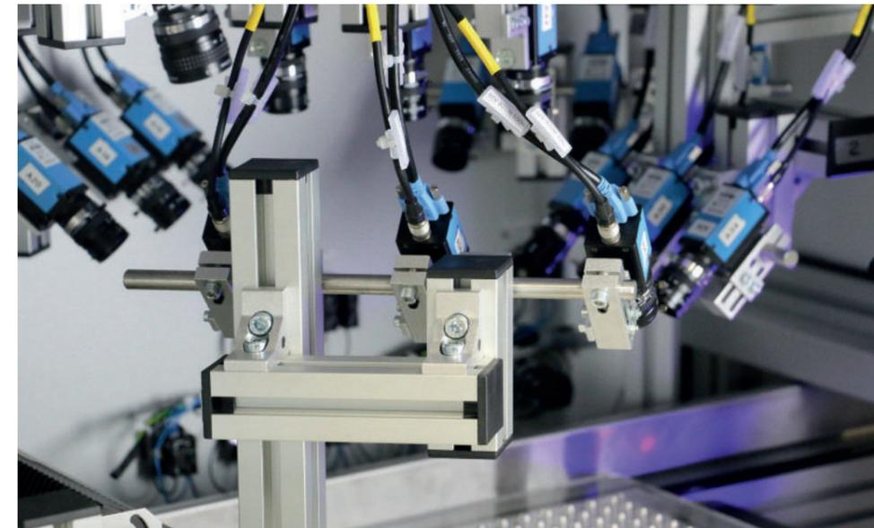
Bild 2 | Die Profile sorgen für maximale Flexibilität der Kameras, die in drei Achsen frei einstellbar sind.
