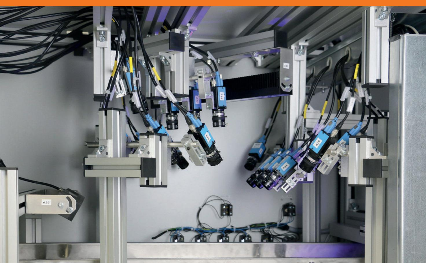
Bild 1 | Bei der Prüfanlage zur optischen Überwachung von lackierten Kleinteilen inspizieren 19 Full-HD Kameras bis zu 250 lackierte Kleinteile im Durchlauf.
