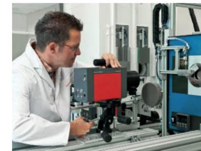
Nutzer der ImageIR Thermografiekameras verfügen dank der HighSense Funktion jetzt über die Möglichkeit, basierend auf der Werkskalibrierung individuelle Messbereiche einzurichten, die
