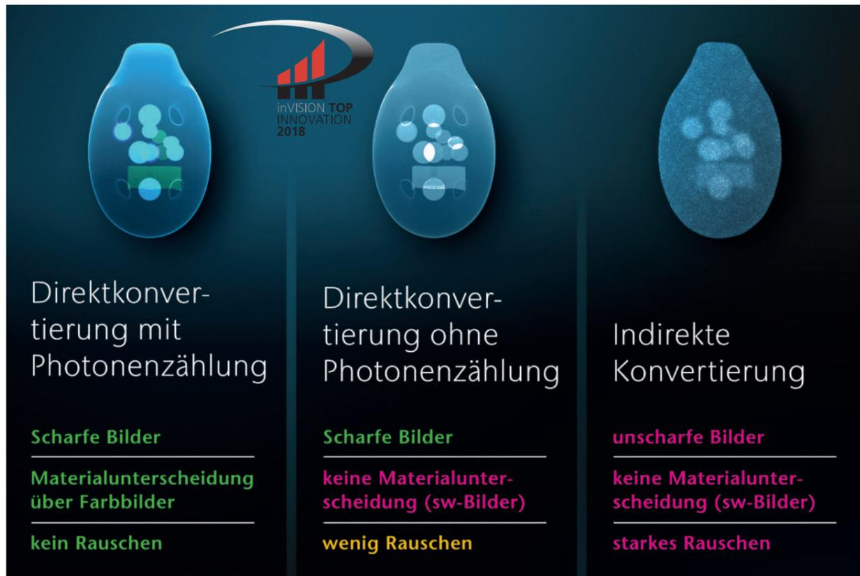
Bild 1 | Vergleich der Bildqualität am Beispiel eines Sparschweins mit direkter Konvertierung mit Einzelphotonenzählung (l.), direkt ohne Photonen-zählung (m.) und indirekter Konvertierung (r.).
