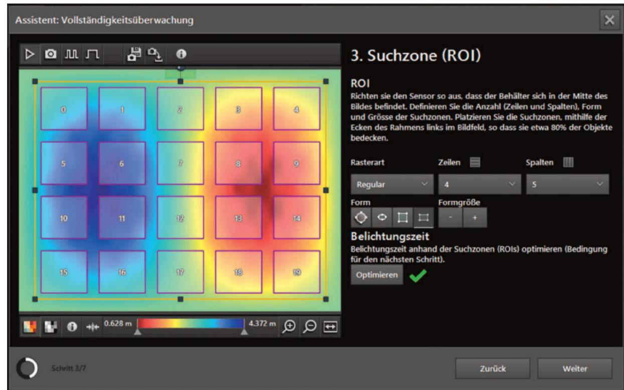
Bild 1 | Besser und ansprechender kann man das kaum machen: Eine Seite im Assistent für die Parametrierung einer Vollständigkeitskontrolle in der Software von ifm
