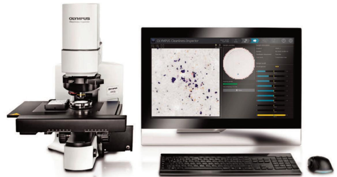
Das CIX90 polarisiert das einfallende Licht und erkennt somit nicht-reflektierende sowie reflektierende Partikel und Fasern bereits während eines einzigen Scans.
