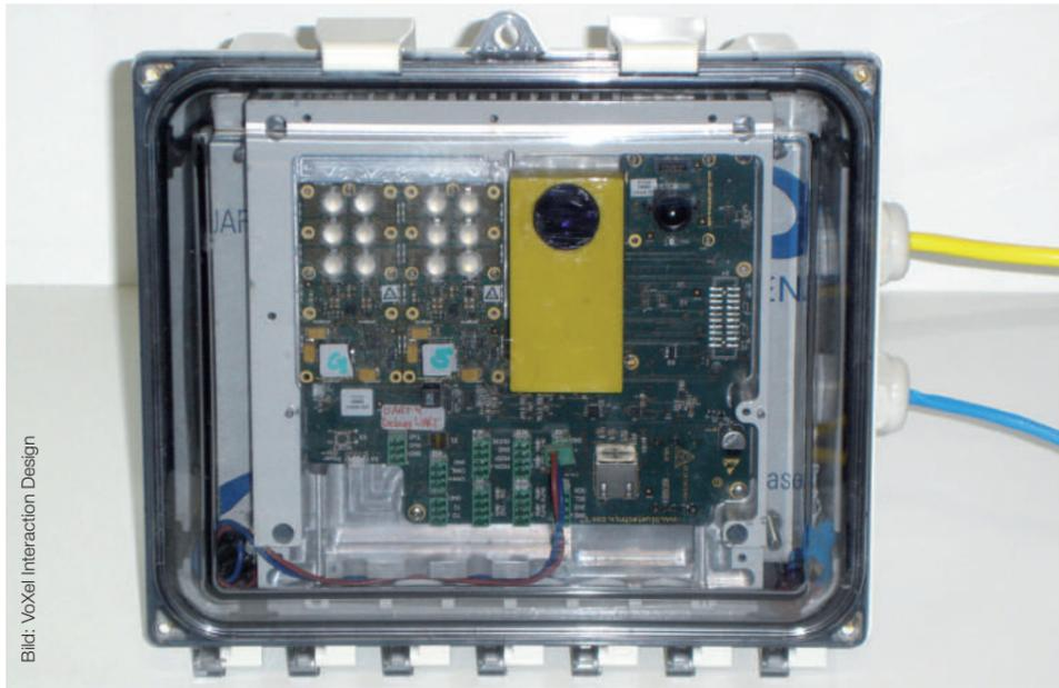
Bild 1 | Die ToF-Kamera in wasserfestem Gehäuse: Der 3D-Sensor verbirgt sich hinter dem gelben Block unter dem Bandpassfilter, links oben sind zwei LED-Emittermodule.
