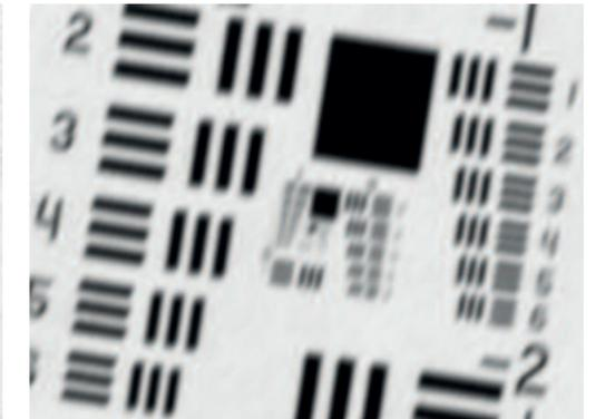
zeigt zwei gemessene telezentrische (preislich ähnliche) Optiken, die beide mit der nahezu gleichen MTF-Leistung in der Objektivachse beworben werden, jedoch zu den Randbereichen hin deutlich unterschiedliches Verhalten zeigen. Beide Optiken haben für die Objektivachse nahezu identische Werte bei 75Lp/mm und 120Lp/mm.
