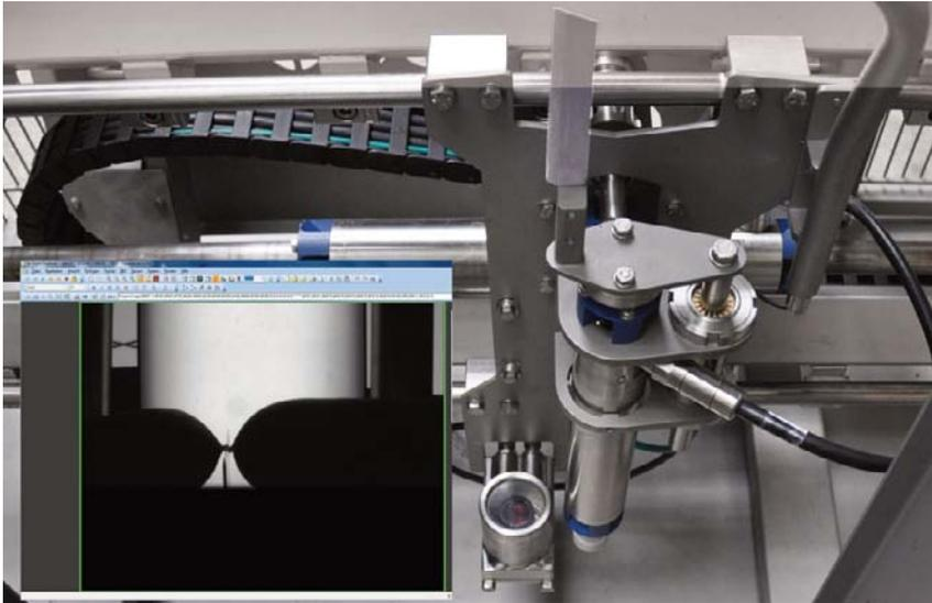
Bild 2 | Herzstück der OptiCut SL-1000: Unten Kamerasystem, oben Beleuchtung, dazwischen das Messer zum Trennen der Wurstpaare.
