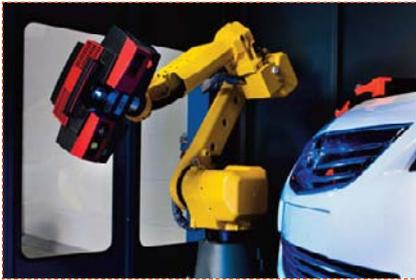
Die Atos ScanBox ist eine mobile Plug&Play-Lösung zur automatisierten 3D-Messtechnik.
