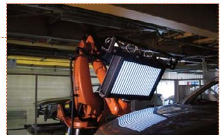
Bis zu vier Systeme an Robotern appliziert kontrollieren Karosserien, die die Messzelle passieren.
