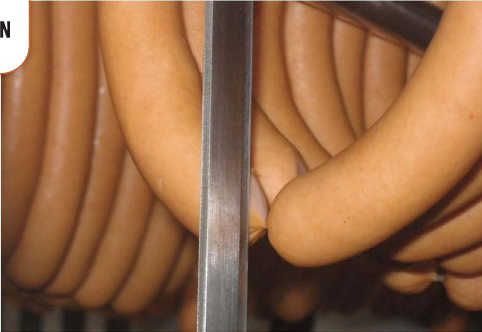
Bild 1 | Mittels intelligentem Kamerasystem erreicht das Messer seine Idealposition in Sekundenbruchteilen. Mehr als 200 Paar Würste schafft es in der Minute.
