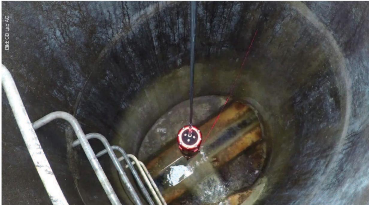
Bild 1 | Zur Vermessung der Schachtwände emittieren Lasermodule ein Muster auf die Schachtwand. Die seitlich angebrachten Sensoren machen synchron mit den Lasermodulen eine 360°-Aufnahme der Schachtwand.
