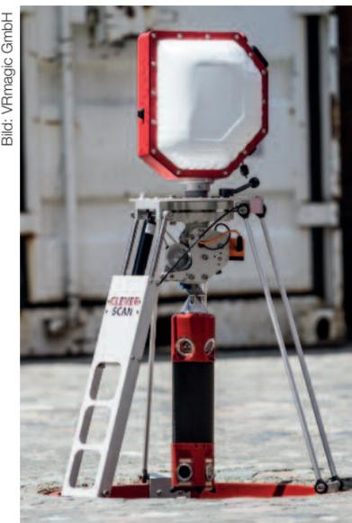
Bild 2 | Im Kopf des Inspektionssystems CleverScan sind vier Lasermodule und eine intelligente Multisensor-Kamera verbaut. Diese ist mit fünf CMOS-Sensoren ausgestattet.
