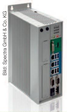
Neben einem redundanten Dual-LAN-Anschluss besitzt der Mini-PC auch einen dritten GbE LAN Port.
