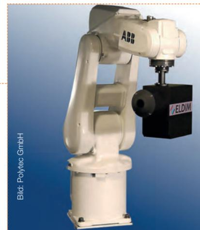
VCProbe misst die Homogenität und Eigenschaften unter verschiedenen Betrachtungswinkeln gekrümmter oder flexibler Displays.
