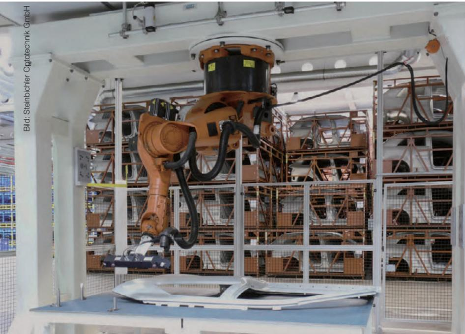
Bild 3 | 2003 fiel bei Audi der Startschuss für eine automatische Oberflächeninspektion im Presswerk, die in einer Prototypenanlage im Presswerk Nord umgesetzt wurde.
