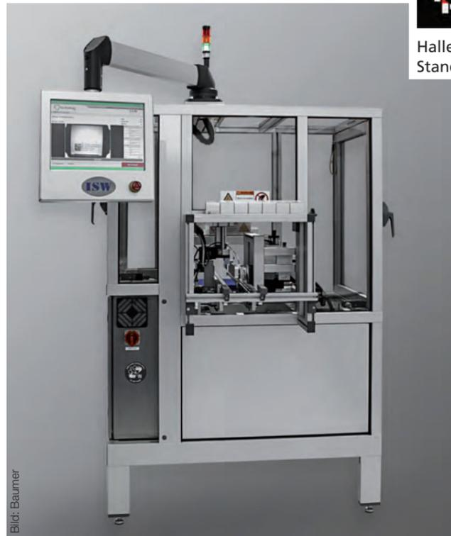
Bild 1 | Die PALC-Anlage kommt für die Serialisierung verpackter pharmazeutischer Produkte zum Einsatz. Zur vollständigen Rückverfolgbarkeit werden fehlerhafte Produkte mittels Druckluft in einen verriegelten Container ausgeworfen und durch das System mitgeloggt.
