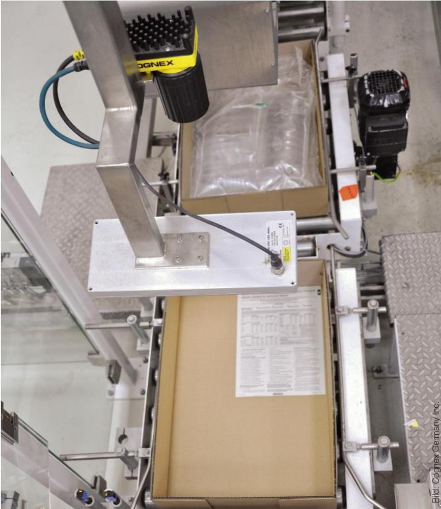
Bild 1 | Vor dem Befüllen der Kartons garantieren die Vision-Systeme das Lesen der Pharmacodes.
