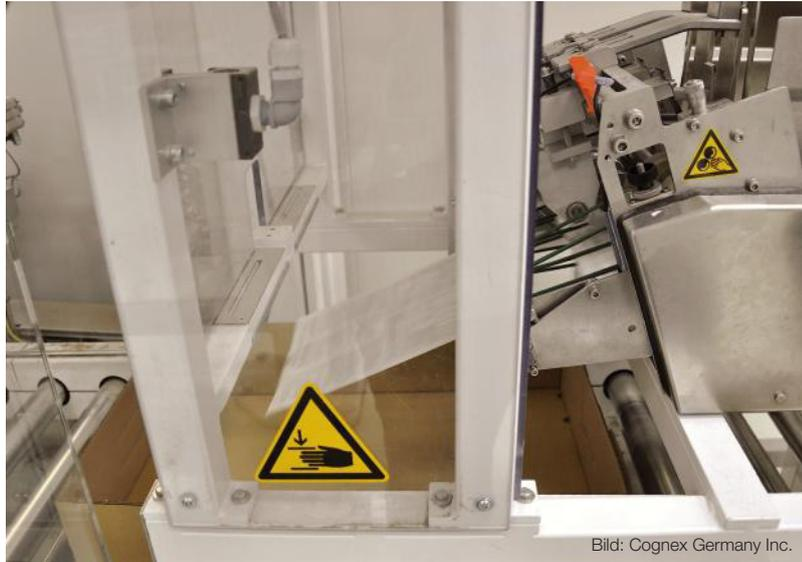
Bild 2 | Automatische Zuführung der Beipackzettel in die Verpackungskartons.
