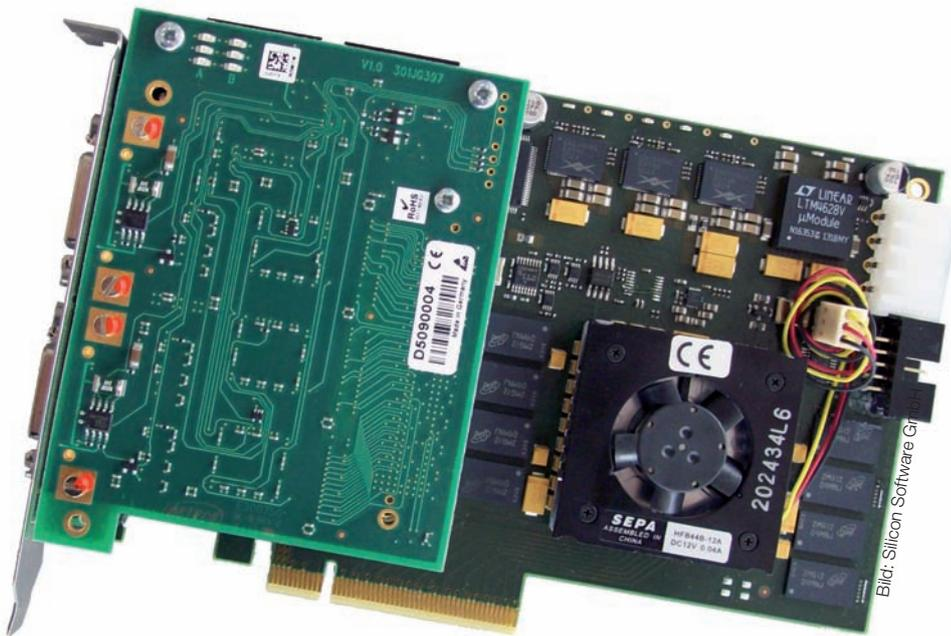
Bild 1 | Der microEnable 5 AD8-PoCL/VD8-PoCL ist der weltweit schnellste Camera Link Framegrabber.
