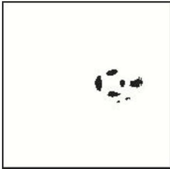
Bild 1a und Bild 1b | Im FPGA berechnetes Quotientenbild einer halbkugelförmigen Schmelze-Anhaftung (links) sowie das daraus erzeugte Binärbild (rechts)
