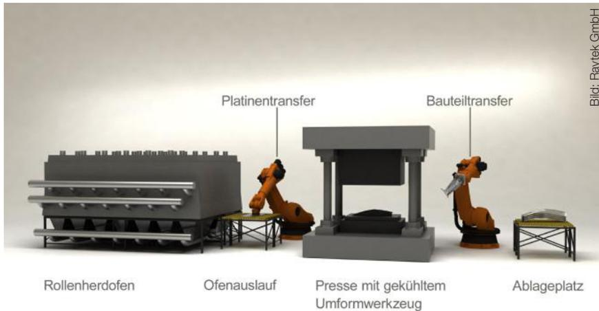
Bild 2 | Der Aufbau einer Formhärtelinie
