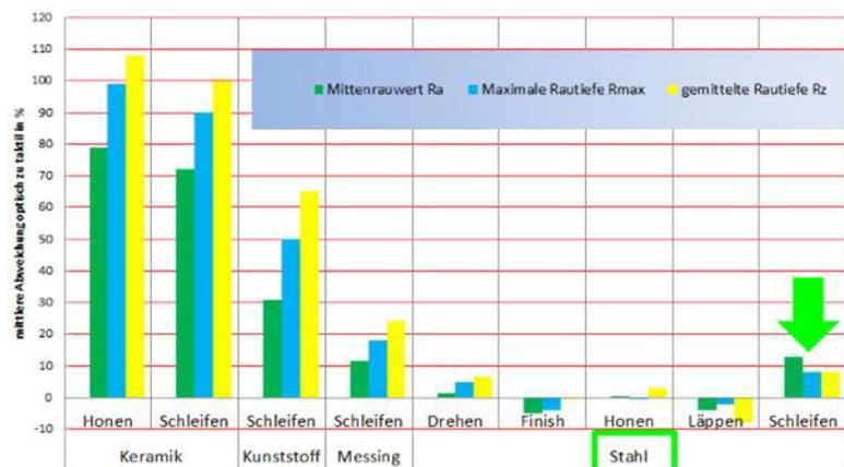
Bild 2 | Die Korrelationsergebnisse zeigen die mittlere prozentuale Abweichung der optisch gemessenen Rautiefe-Ergebnisse von den taktil gemessenen. Beim Schleifen (Stahl) ist die Differenz der Messverfahren kleiner zehn Prozent.
