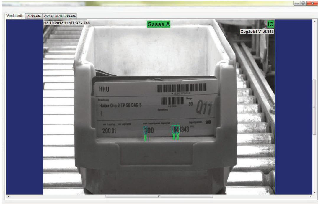
Bild 1 | Das System liest automatisch die Zahlencodes auf Etiketten von Kleinladungsträgern.
