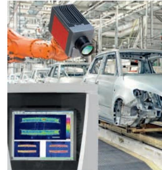
Detektorformate bis zu (1.280 x 1.024) IR-Pixel
