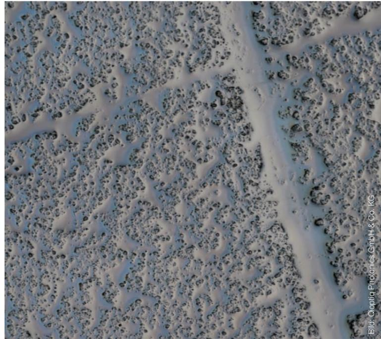
Bild 1 | Reliefartiger Bildeindruck am Beispiel von geschliffenem Glas mit Unregelmäßigkeiten im DIC (differential interference contrast) – Ausschnitt 2,5x2,1mm<sup>2</sup>
