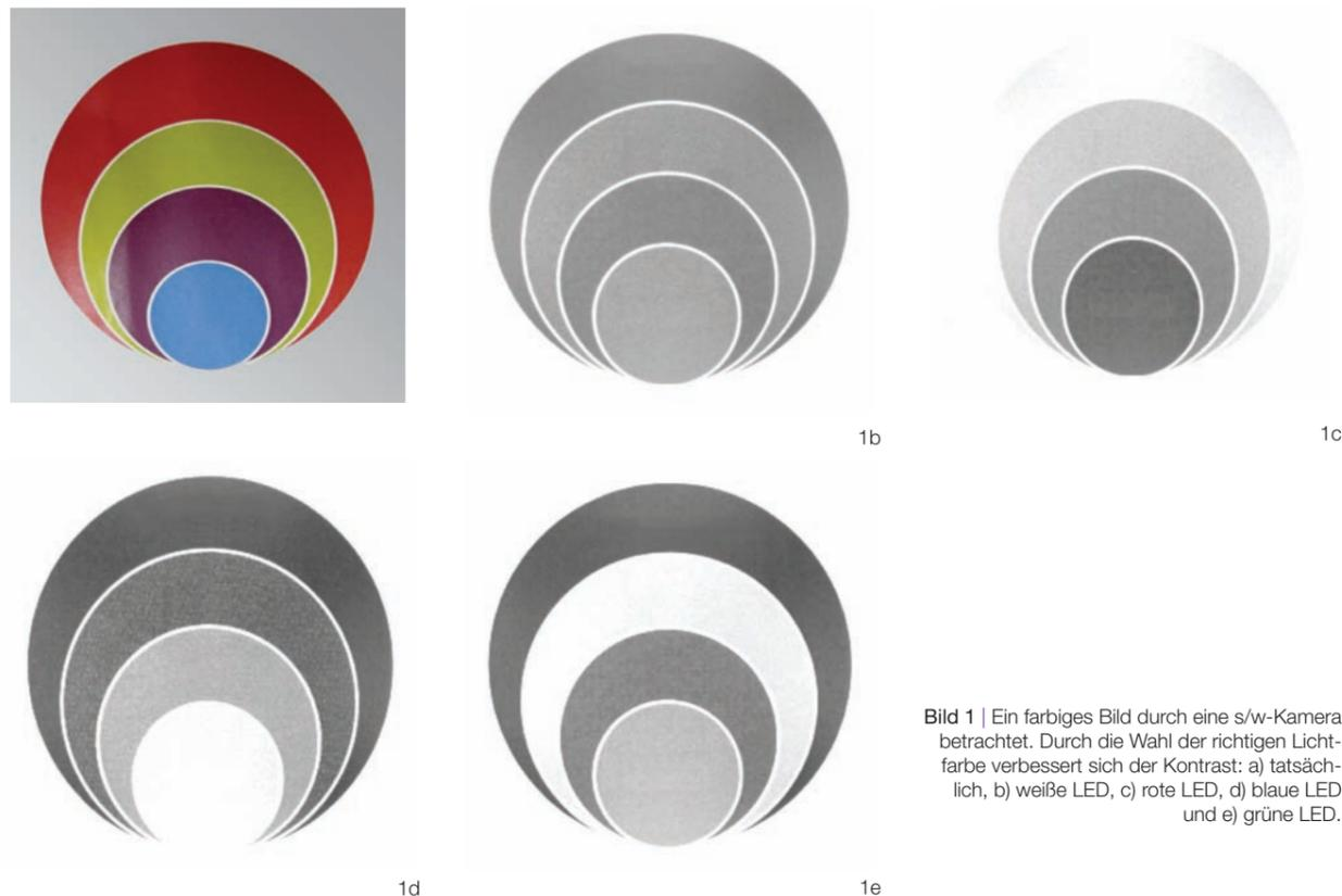
Bild 1 | Ein farbiges Bild durch eine s/w-Kamera betrachtet. Durch die Wahl der richtigen Lichtfarbe verbessert sich der Kontrast: a) tatsächlich, b) weiße LED, c) rote LED, d) blaue LED und e) grüne LED.
