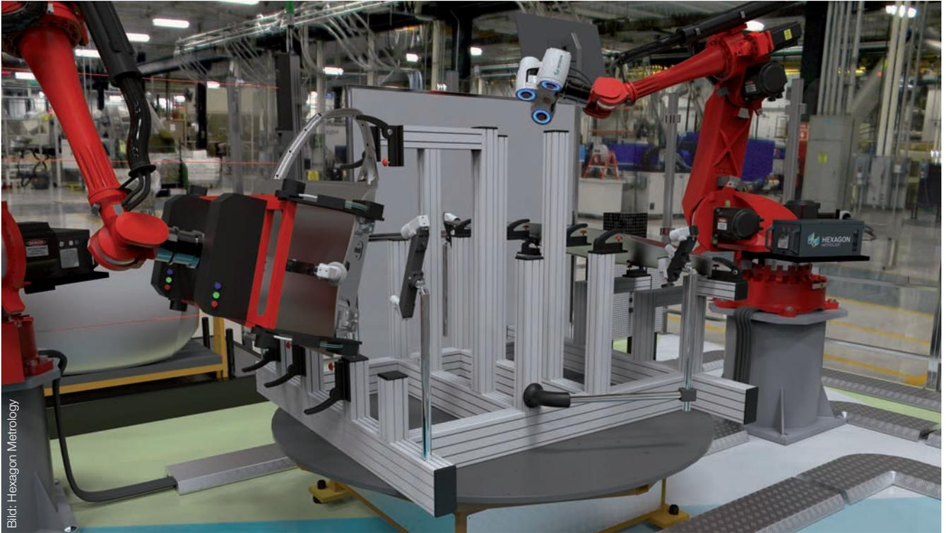
Bild 1 | Die unmittelbar in die Fertigungsstraße integrierte Zelle misst alle produzierten Bauteile vollautomatisch.
