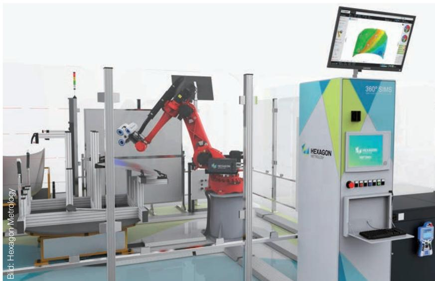
**Bild 2** | Eine 360° SIMS-Messzelle misst verschiedene Anbauteile, die durch ein fahrerloses Transportfahrzeug (AGV) angeliefert werden. Die Messzelle visualisiert online detaillierte Messergebnisse.
