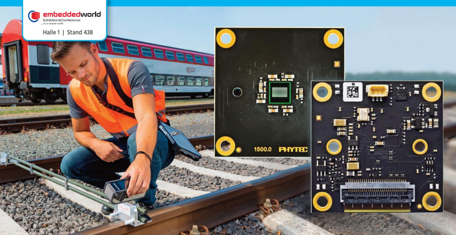
Bild 1 | Das Kameramodul VM-016 ist mit der phycam MIPI CSI-2-Schnittstelle verfügbar.
