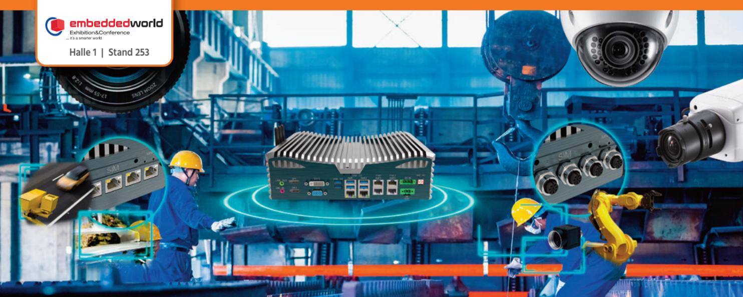
Bild 1 | Das kompakte, lüfterlose Eagle-Eyes-Bildverarbeitungssystem mit dem KI-Softwarepaket Ekit ermöglicht eine vorausschauende Wartung und unterstützt bis zu zwölf PoE-Kameras.
