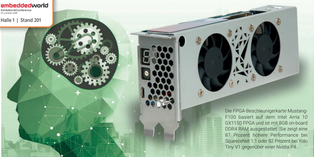
Die FPGA-Beschleunigerkarte Mustang-F100 basiert auf dem Intel Arria 10 GX1150 FPGA und ist mit 8GB on-board DDR4 RAM ausgestattet. Sie zeigt eine 87 Prozent höhere Performance bei SqueezeNet 1.1 oder 82 Prozent bei Yolo Tiny V1 gegenüber einer Nvidia P4.
