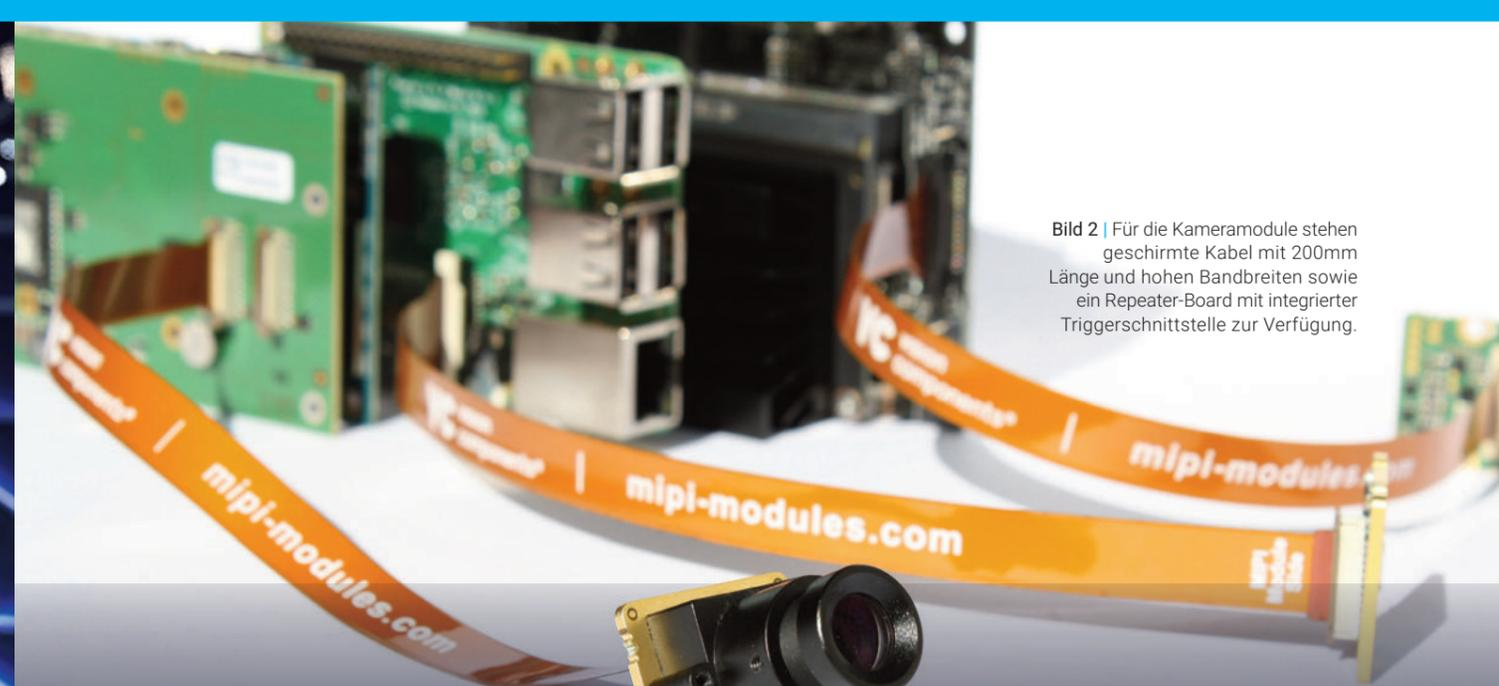
**Bild 2** | Für die Kameramodule stehen geschirmte Kabel mit 200mm Länge und hohen Bandbreiten sowie ein Repeater-Board mit integrierter Triggerschnittstelle zur Verfügung.
