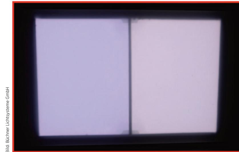
Bild 2 | Referenzleuchte mit zwei nebeneinander liegenden, homogen leuchtenden Flächen. Jede Fläche ist getrennt über vier Farbkanäle steuerbar. Damit lassen sich unterschiedliche Farben bzw. Spektren realisieren.
