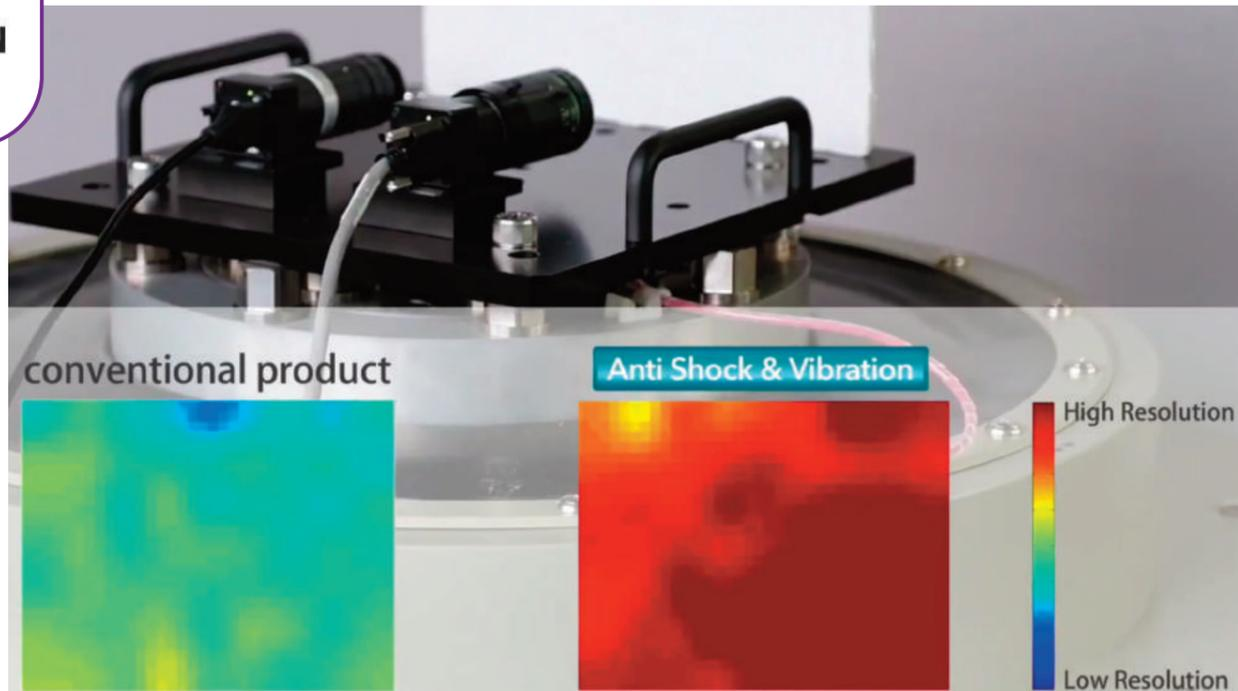
Bild 1 | Bei dem Stresstest zeigte sich, dass bei vielen Objektiven (l) eine deutliche Abnahme des Kontrasts und damit des Auflösungsvermögens zu beobachten ist. Dies ist nicht der Fall bei Objektiven, die eine elastische Fixierung der internen Linsenanordnung haben.
