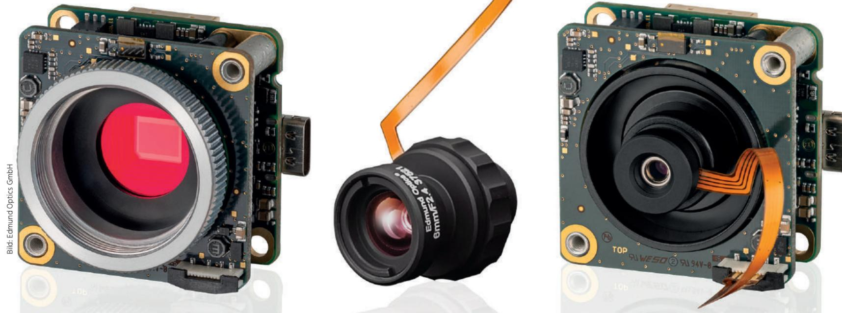
Bild 1 | Die uEye LE USB3.1 Gen 1 AF (Active Focus) Board-Level-Kameras mit integrierter Flüssiglinsensteuerung gibt es mit S-Mount und CS-/C-Mount. Kompatibel mit Hard- und Software sind alle Objektive, die auf einer Corning Varioptic Flüssiglinsen basieren, wie z.B. die Objektivsysteme von Edmund Optics.
