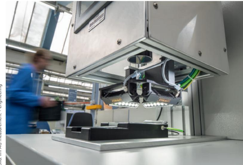
Bild 2 | Verifikations-Station zur manuellen Qualitätskontrolle von Data Matrix Codes.
