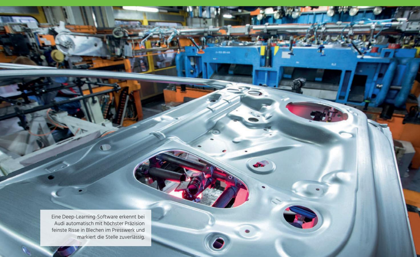
Eine Deep-Learning-Software erkennt bei Audi automatisch mit höchster Präzision feinste Risse in Blechen im Presswerk und markiert die Stelle zuverlässig.
