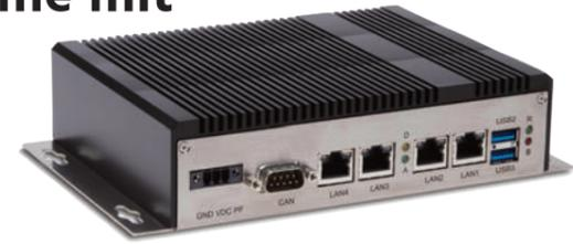
PCs sind lüfterlos, wartungsfrei und eignen sich für den Temperaturbereich von -40 bis +70°C. Zur Systemanbindung verfügen sie über ein flexibles Schnittstellenlayout und es lassen sich WIFI-, GPS- sowie LTE-Funktionen ergänzen.
