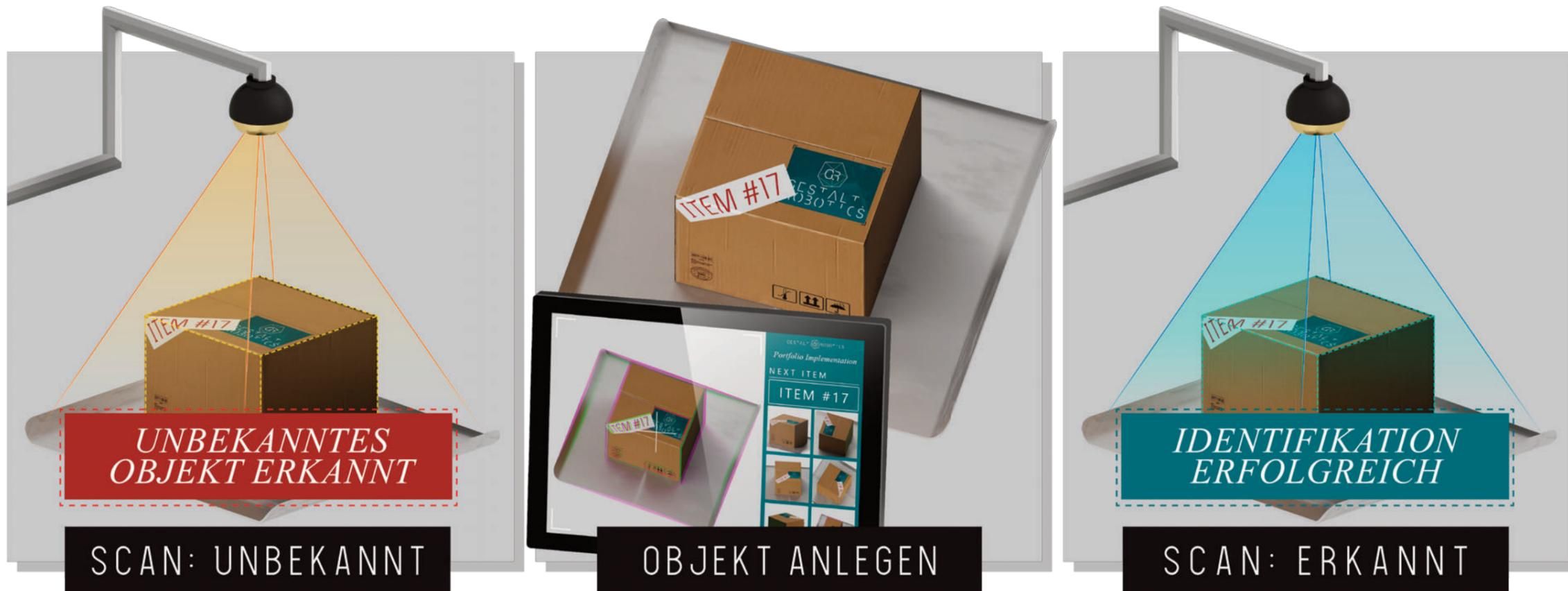
Bild 1 | Echtzeitlernende Objekterkennung: ein unbekanntes Objekt liegt vor (l), der Nutzer macht drei bis fünf Fotos vom neuen Objekt mit einem Tablet oder Smartphone (m) und wenige Sekunden später ist das System in der Lage das neue Objekt zu erkennen.
