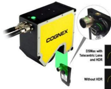
Der hochauflösende 3D-Sensor DSMax bietet 2.000 Profilpunkte und Scanraten von bis zu 18kHz bei vollem Messbereich. Durch die Kombination aus telezentrischen Objektiv und gerichteter Laserlinie werden die abgeschatteten Bereiche reduziert. Der Sensor verfügt über HDR-Funktion, Hochgeschwindigkeits-Bildgeber, eine druckbasierte Abtasttechnologie und verwendet das CoaXPress-Protokoll für einen schnellen Datendurchsatz.
