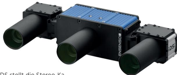
IDS stellt die Stereo-Kamera Ensenso XR vor. Diese kann 3D-Punktwolken selbst berechnen und sendet die Daten anschließend per Ethernet oder WLAN an einen Host-PC zur weiteren Verarbeitung. Zum Serienstart im Frühjahr 2019 sind sowohl Varianten mit GigE uEye CP- als auch robuste GigE uEye FA-Industriekameras (Schutzart IP65/67) mit 1,6 und 5MP-Sensoren geplant.
